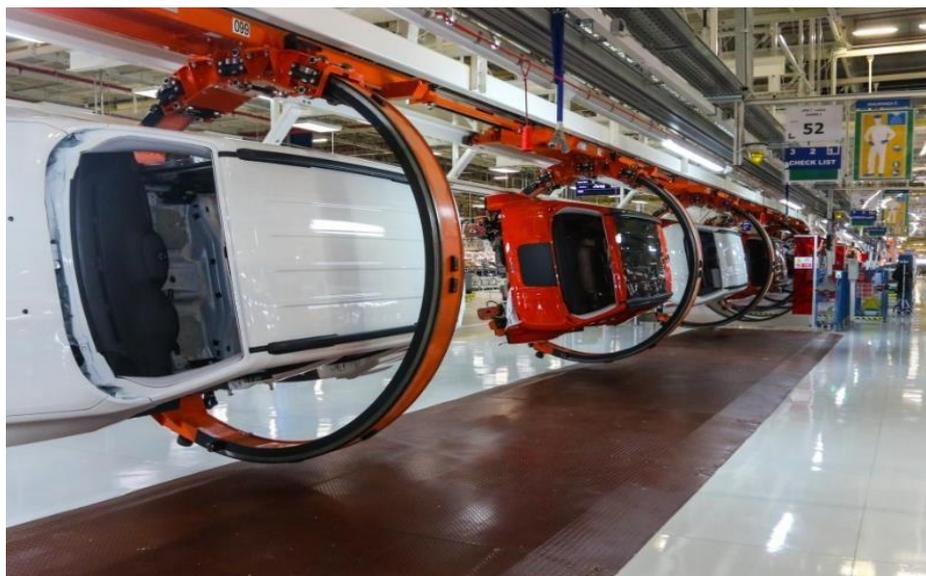
*Figura 22 - Fase di assemblaggio di Jeep Renegade*
