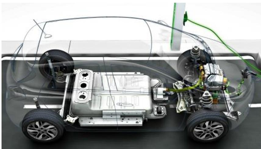
*Figura 8 – Vista del pacco batteria e dell'unità di trazione di un veicolo BEV*
