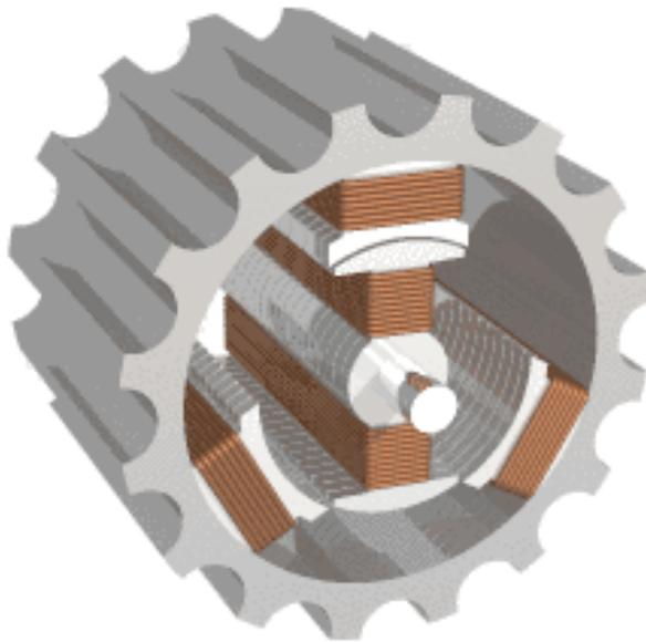
Figura 11 – Schema di un motore brushless
