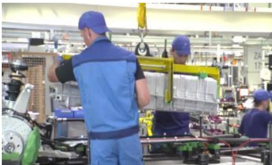
*Figura 39 - Assemblaggio manuale del pacco batteria*
