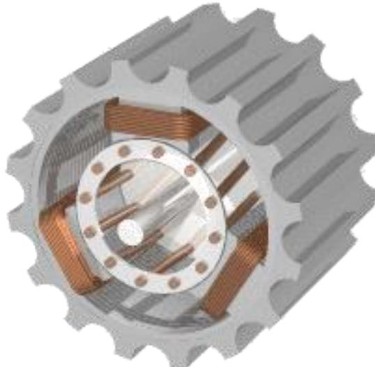
*Figura 10 – Schema di un motore asincrono o a induzione*
