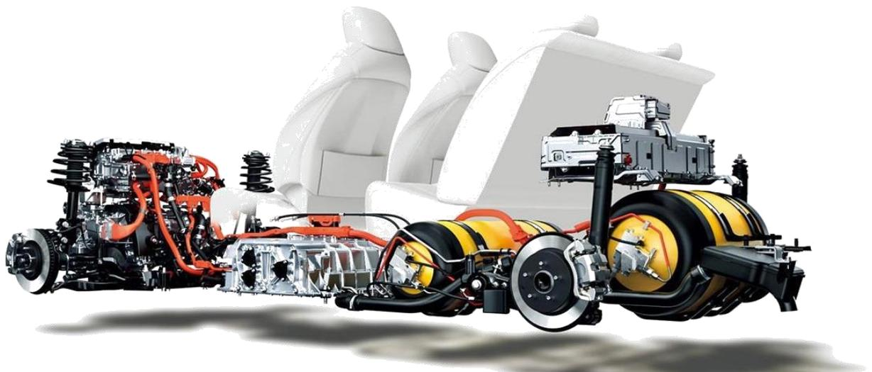
Figura 7 - Architettura di un veicolo elettrico FCELL
