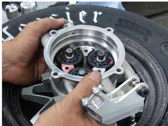
Figure 2.8. DHBW Engineering Stuttgart e.V. transmission
