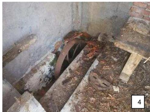
volano per il funzionamento delle macchine
