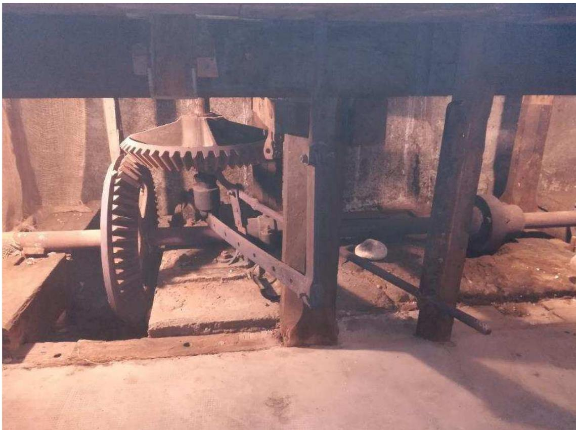
Vista degli ingranaggi di collegamento per il funzionamento della macina
