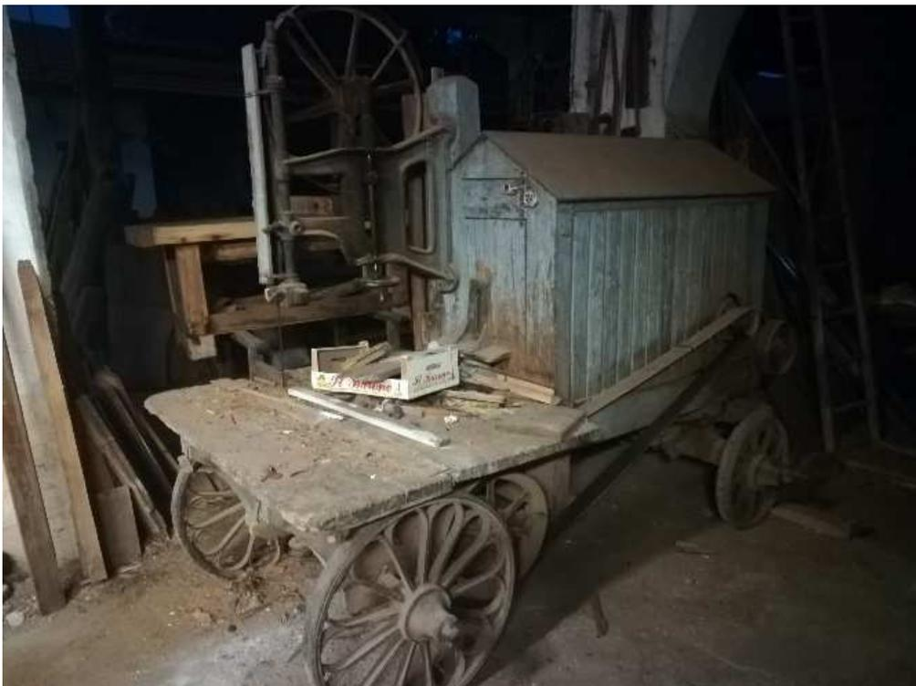
Sega a bindello su ruote dotata di motore elettrico per il suo funzionamento
