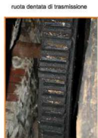
ruota dentata di trasmissione
