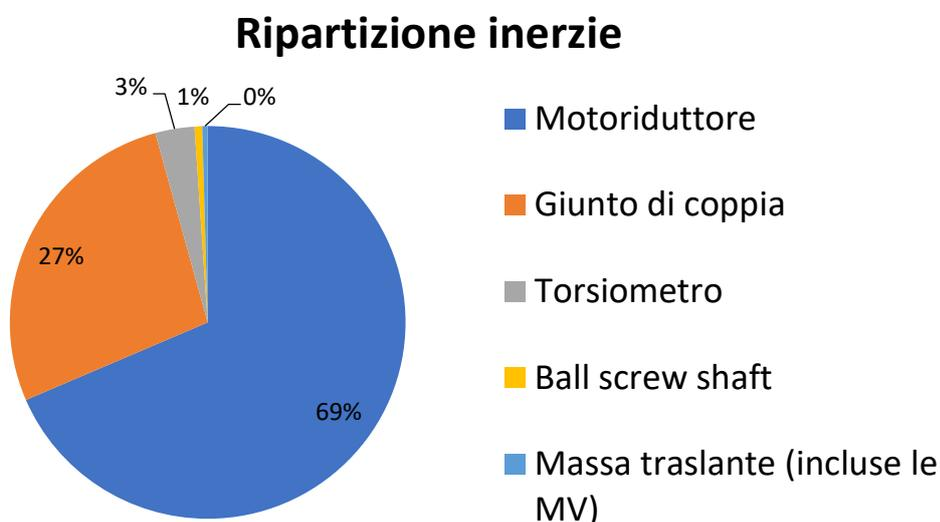
Figura 41: Grafico a torta della ripartizione delle inerzie ad alimentazioni spente.
