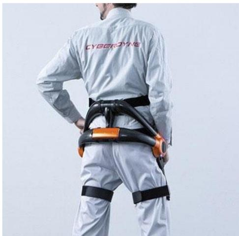
Figura 55 Esoscheletro per il supporto lombare HAL
