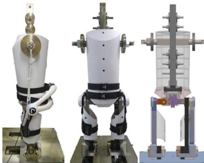
Figura 56 Banco prova per test sull'esoscheletro HAL
