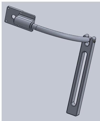
Figura 20 complessivo del leglink dell'esoscheletro
