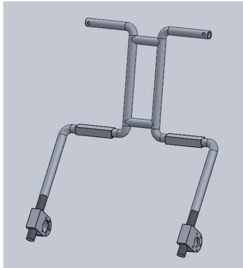
Figura 19 struttura del backframe dell'esoscheletro
