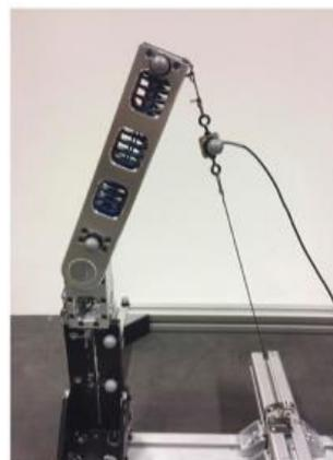
Figura 12 test su giunto esoscheletrico provvisto di attuttore [5]
