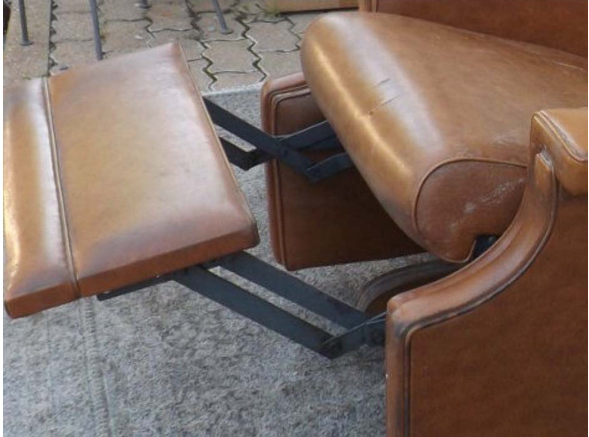
Figura 41: Esempio di meccanismo di fuoriuscita del cuscino per allungare le gambe presente su una poltrona[18].
