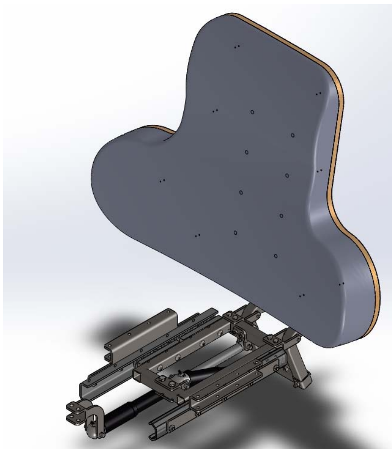
Figura 121: Vista isometrica del meccanismo di inclinazione e di regolazione della profondità dello schienale tratta dal CAD Solidworks separato dal resto della sedia.
