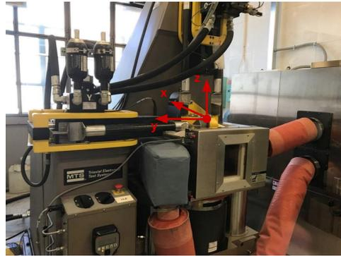
Figura 3.3: Dettaglio cella climatica con sistema di riferimento del banco [1]
