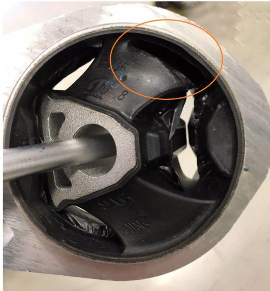
**Figura 9.2:** Modalità di rottura della bielletta 5ISO 2 in seguito al ciclo affaticante LC isodanno a 100°C
