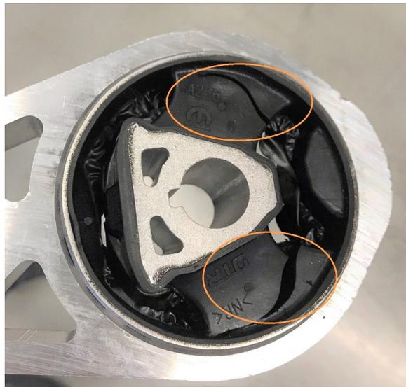
**Figura 9.3:** Modalità di rottura della bielletta 5ISO 3 in seguito al ciclo affaticante LC isodanno a 100°C
