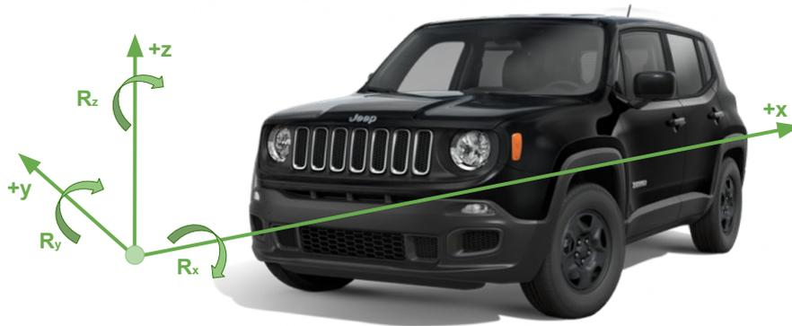
Figura 3.6: Sistema di riferimento della vettura
