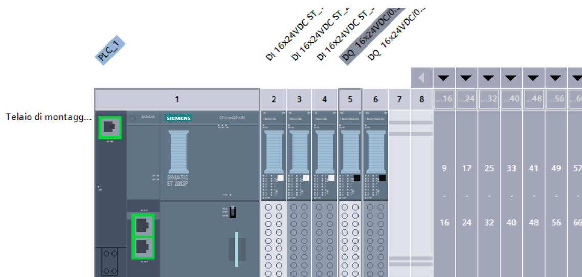
Figura 5. 22- CPU con schede DI e D
