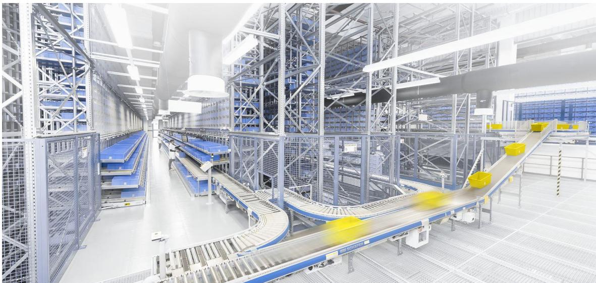
*Figura 2. 2 - Sistema di movimentazione colli su rulliere*
