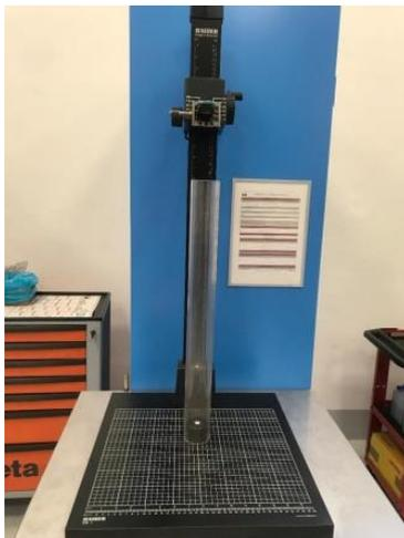
*Figura 3.4: Strumento per urti ad energia controllata*
