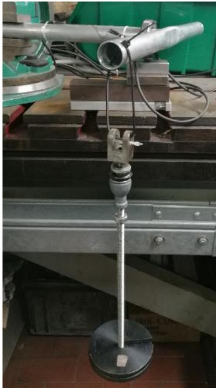
*Figura 31 Configurazione per prove di acquisizione a torsione pura.*
