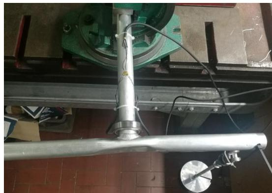
*Figura 28 Configurazione acquisizione caricando dal lato b2*
