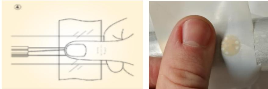
Figura 20 Incollaggio e pressione con foglio di polietilene
