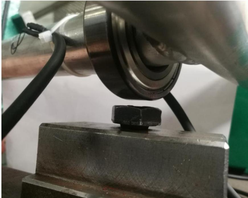
*Figura 29 Posizionamento vite per realizzare appoggio*
