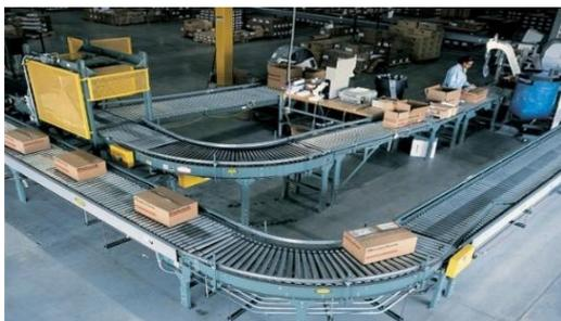
Figura 1.2 Sistema di movimentazione continuo a rulliera(Fonte:Hieker,2019,[5])
