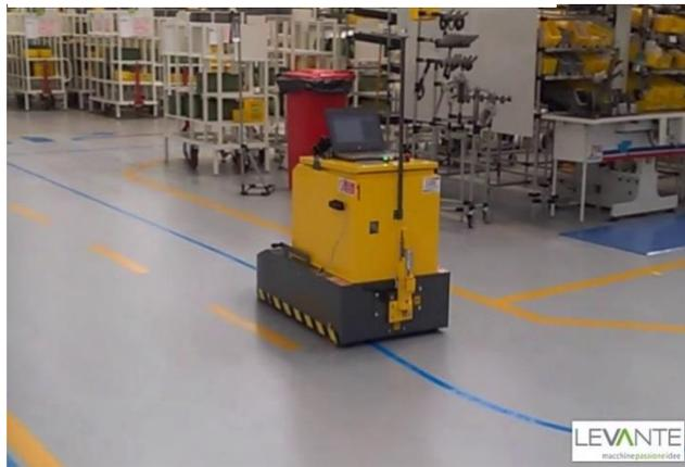
Figura 1.17 Guida ottica a nastro colorato
