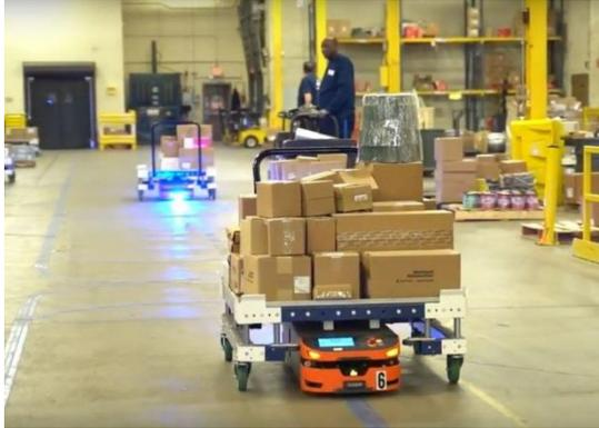
contiene l'unità di carico al di sopra) e lo solleva di pochi millimetri. Questo tipo di AGV è dotato di uno o più pistoni, sul dorso, che si sollevano e s'inseriscono in apposite cavità sul carrello in modo da tenerlo ben saldo al robot. La figura 1.24
