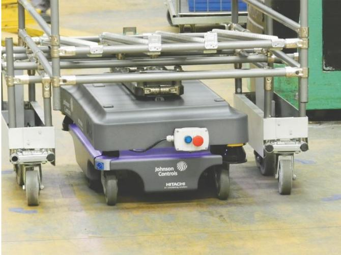
Figura 1.27 AGV con sistemi di sicurezza (Fonte: MiR,2019,[31])
