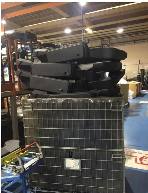
*Figura 3.25 Eccesso di wip accatastato*
