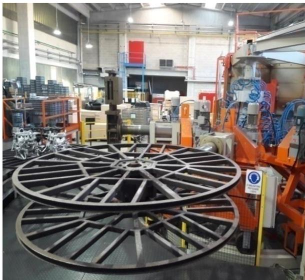
*Figura 2.8 Ruote installate sui bracci dei macchinari che consentono di montare più stampi e di produrre contemporaneamente più pezzi (Laganà, 2019)*
