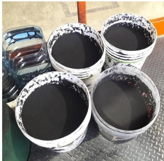
*Figura 2.9 Secchi di polvere di materiale plastico già pesati a bordo macchina e pronti da inserire nello stampo (Laganà, 2019)*
