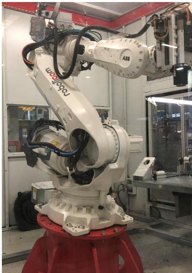
Figura 2.14 Braccio robotizzato "Roboticom" utilizzato nella finitura di semilavorati
