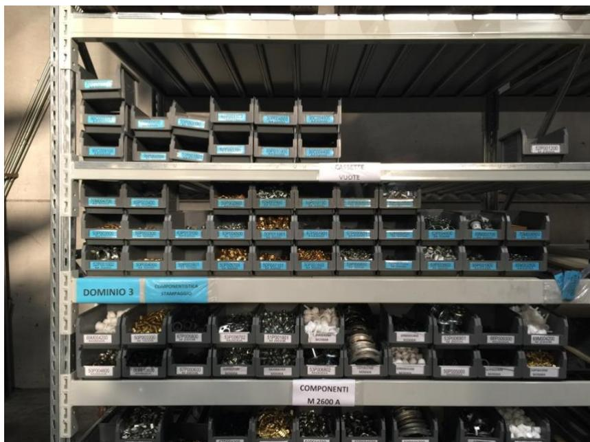
*Figura 3.43 Scaffalatura predisposta con il colore identificativo del D3 per una facile identificazione da parte dei carrellisti interni*
