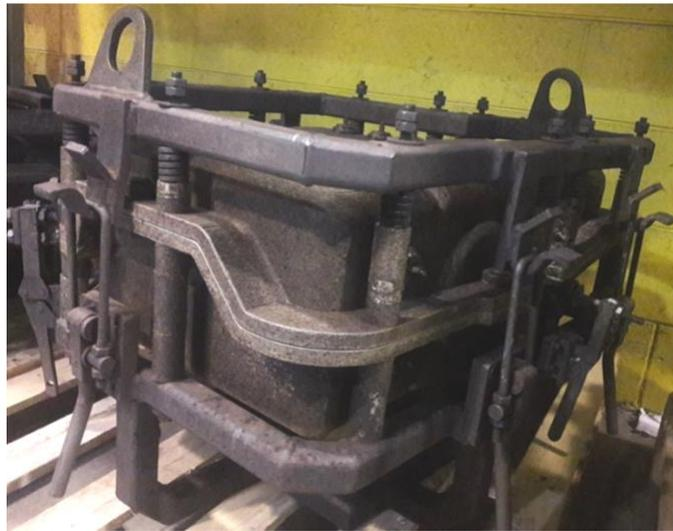
*Figura 2.10 Esempio di stampo tradizionale per la produzione di serbatoi urea*
