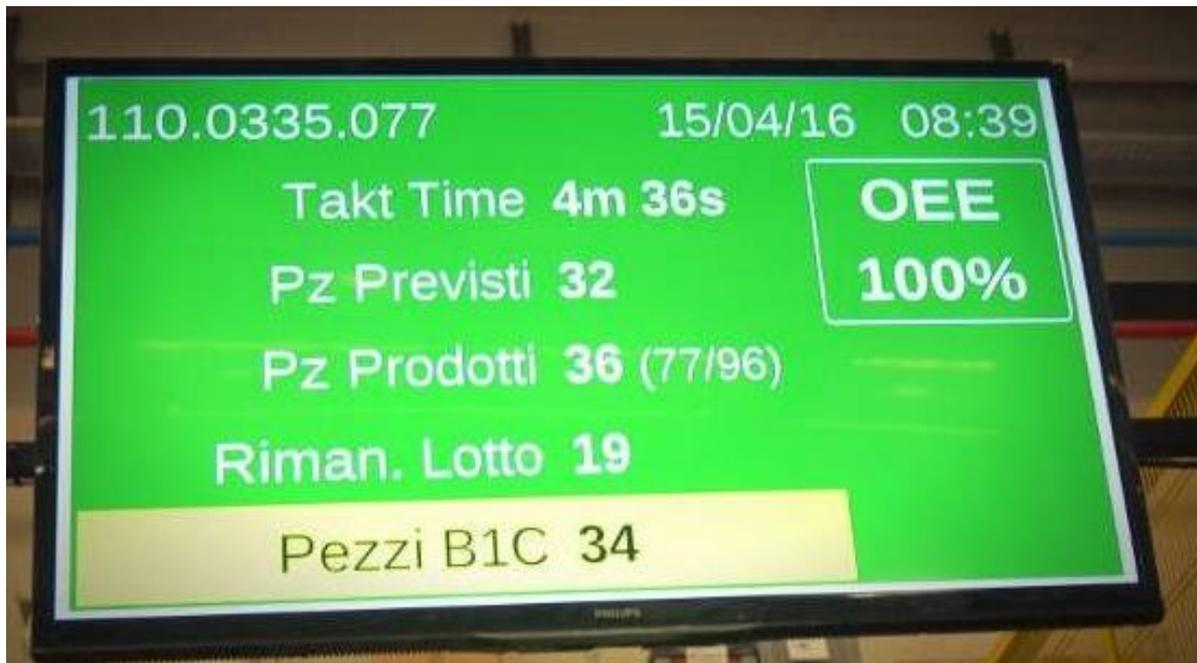
Figura 4.1 Esempio di una schermata Andon all'interno di un impianto produttivo (Carbone-MyNext)
