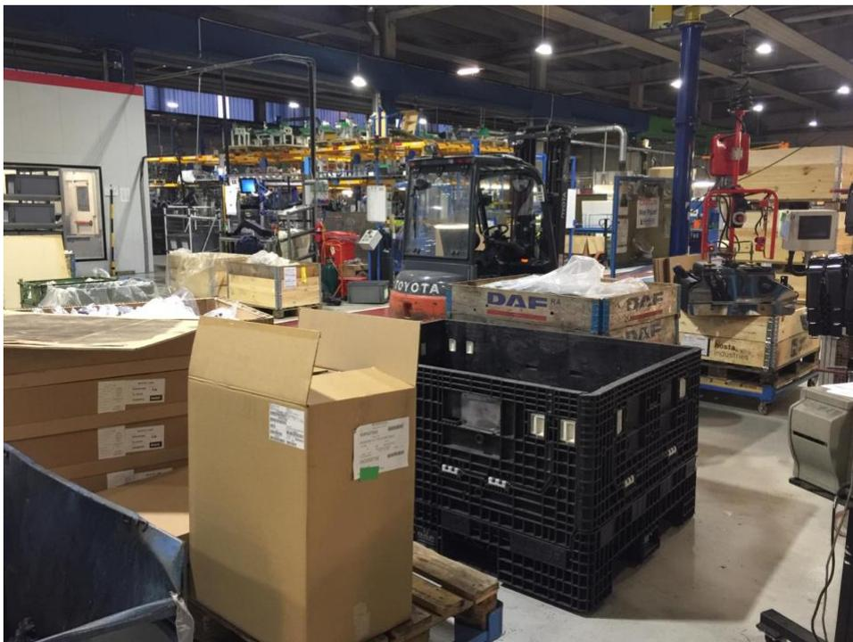
*Figura 3.16 Zona terminale del banco di finitura poco strutturata, che causa rallentamenti ed intralci agli operatori ed ai carrellisti*
