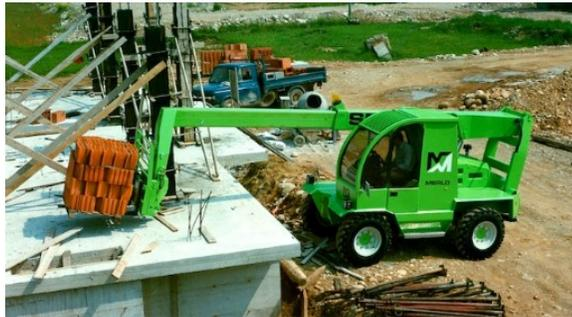
*Figura 19 – SM 30, il primo sollevatore telescopico (www.merlo.com)*
