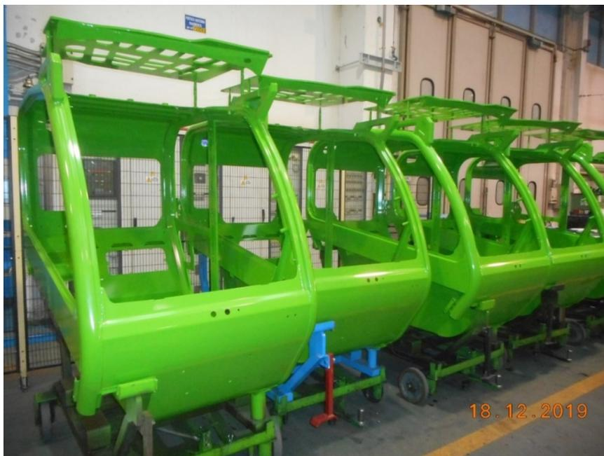
*Figura 46 – Scocche delle cabine verniciate, in attesa di essere allestite*
