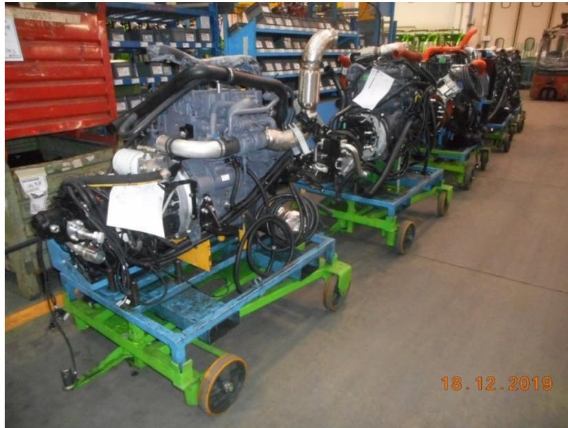
*Figura 44 – Treno di carrelli dei motori assemblati*
