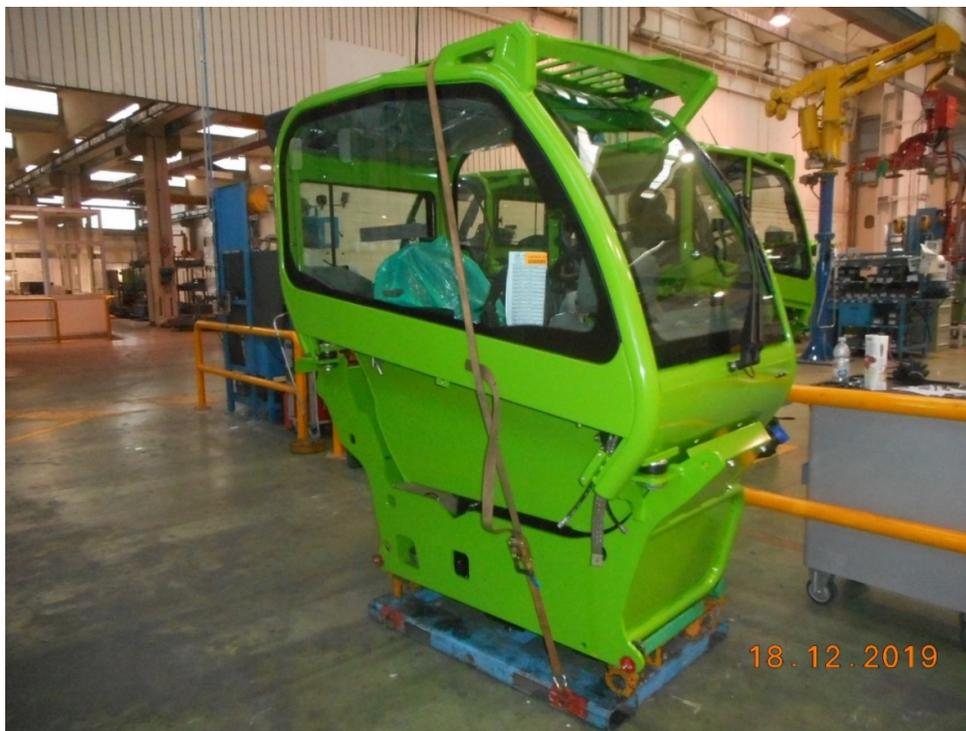
*Figura 48 – Cabina allestita, pronta per essere condotta alla linea di montaggio*
