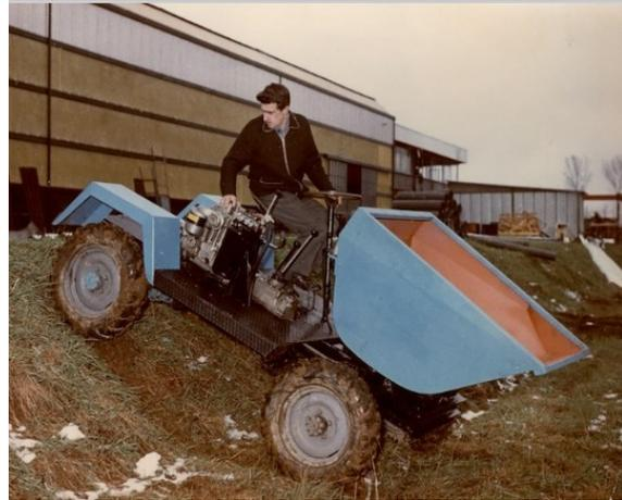
*Figura 17 e 18 – Il primo modello di betoniera auto-caricante e di dumper (www.merlo.com)*
