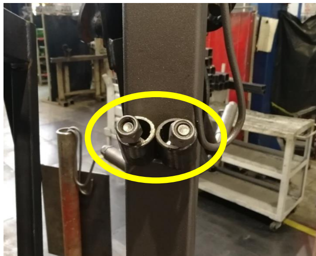
Figura 4.8 Supporto inserito nel grappolo per contenere viti e bulloni
