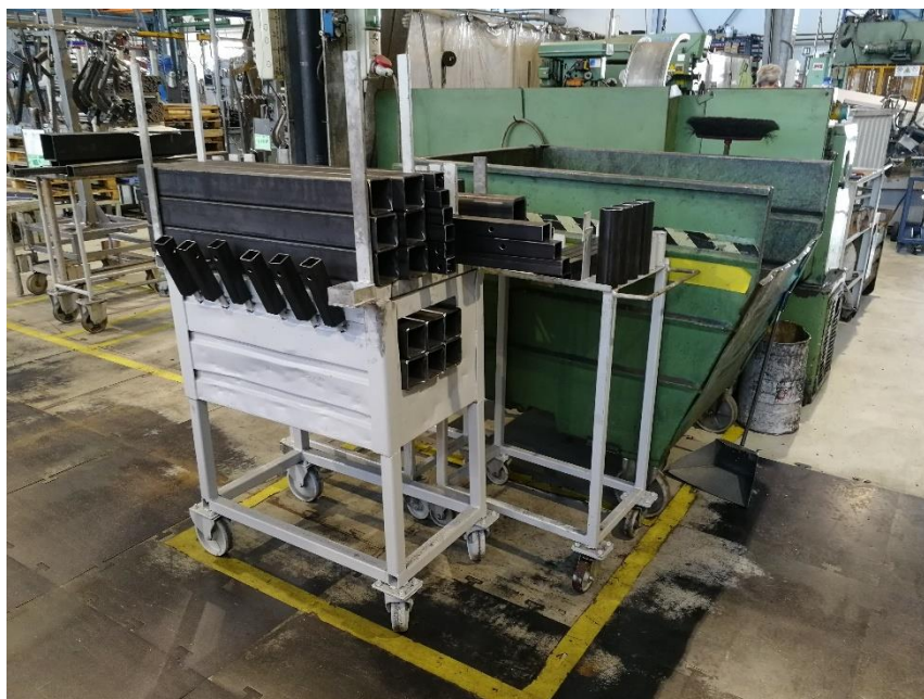
Figura 4.10 Il carretto contenente il materiale per l'appensione e il montaggio rifornito dal reparto taglio
