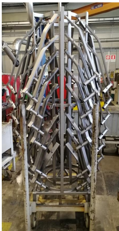
Figura 4.15 Disposizione e separazione delle lame sul grappolo
