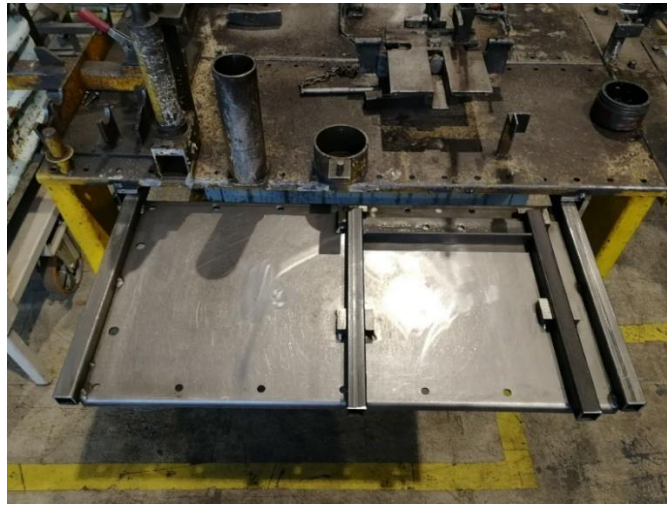
Figura 4.2: Dima di saldatura per i cavalletti unificata con la maschera principale
