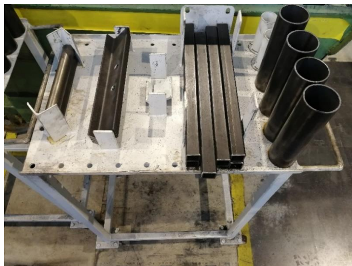
Figura 4.3 Carrello poka-yoke per il materiale della zincatura dei due modelli
