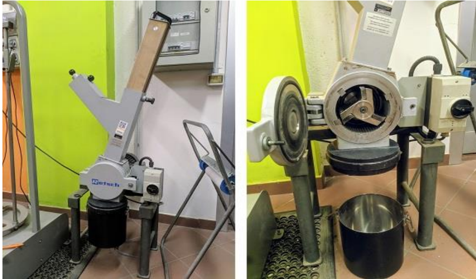
Figura 17. Molino a coltelli
