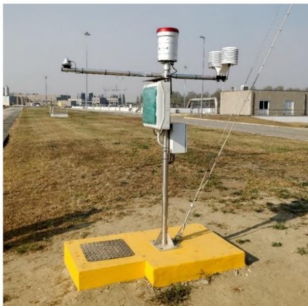
Figura 5.12: Centralina meteo installata in impianto.
