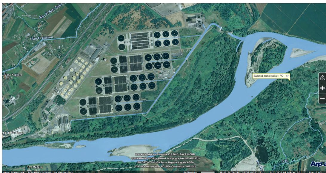
Figura 5.4: Idrografia dell'area circostante l'impianto. Si notano gli scarichi verso il Po provenienti dalla linea acque.
