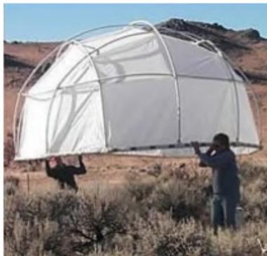
Figura 3.4: Camera statica a cupola per le emissioni di  $CO_2$  dai terreni (dott. John A. Arnone).
