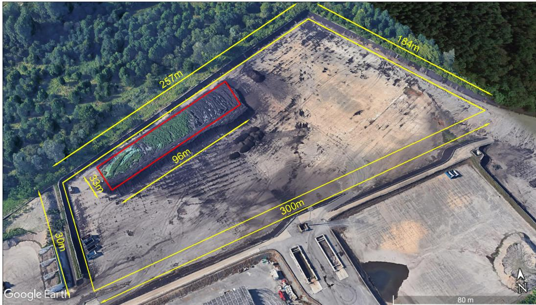
Figura 5.34: Piazzale di stoccaggio dei fanghi provenienti dall’impianto di trattamento.
