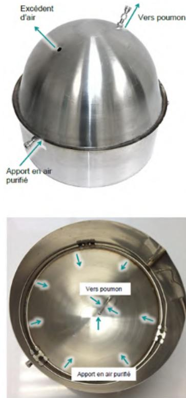
Figura 3.10: Flux chamber progettata da Osmotech [80].
