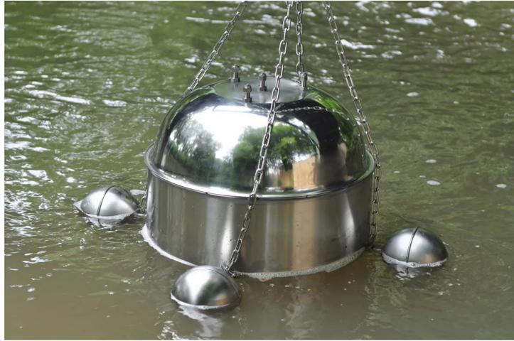
Figura 3.9: Applicazione della camera di flusso su una sorgente liquida [79].
