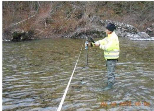
Con il campionamento delle velocità si otterrà il suo profilo nella sezione (con una risoluzione spaziale definita dagli intervalli di campionamento).
