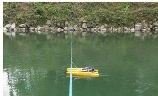
Lo strumento non potrà operare in condizioni di portate eccezionalmente elevate o in presenza di abbondante trasporto solido (caratteristiche tipiche delle piene alluvionali) in quanto potrebbe essere danneggiato o portato via dalla corrente rendendo impossibile le misurazioni.
