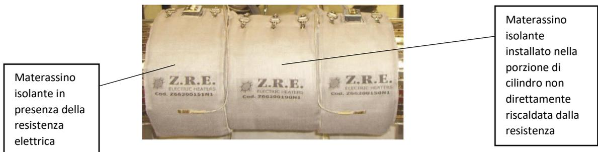
Figura 78: montaggio materassino su cilindro pressa (www.zre.it).
