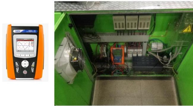
Figura 88: Analizzatore di rete e installazione per la misurazione
