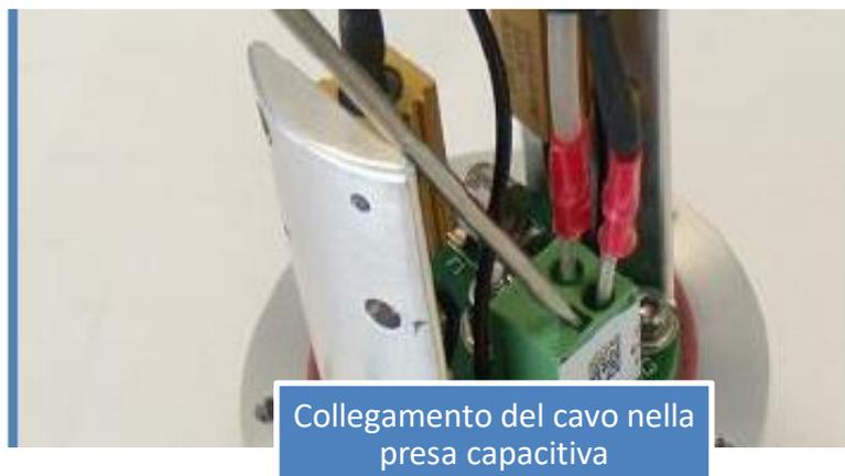
Figura 4.2.7. Fasi di collegamento del cavo coassiale
