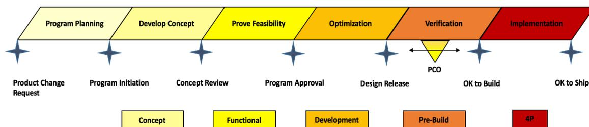
Figura 2.2: Flusso GPD 2.0 con strutture di prototipi e di pre-produzione (Fonte: Manuale CNH Industrial "GPD 2.0 Process Basics Training – Global Product Development Process")
