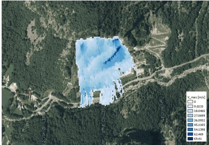
Figura 6-6 Valori delle velocità raggiunte dai blocchi lungo il versante.
