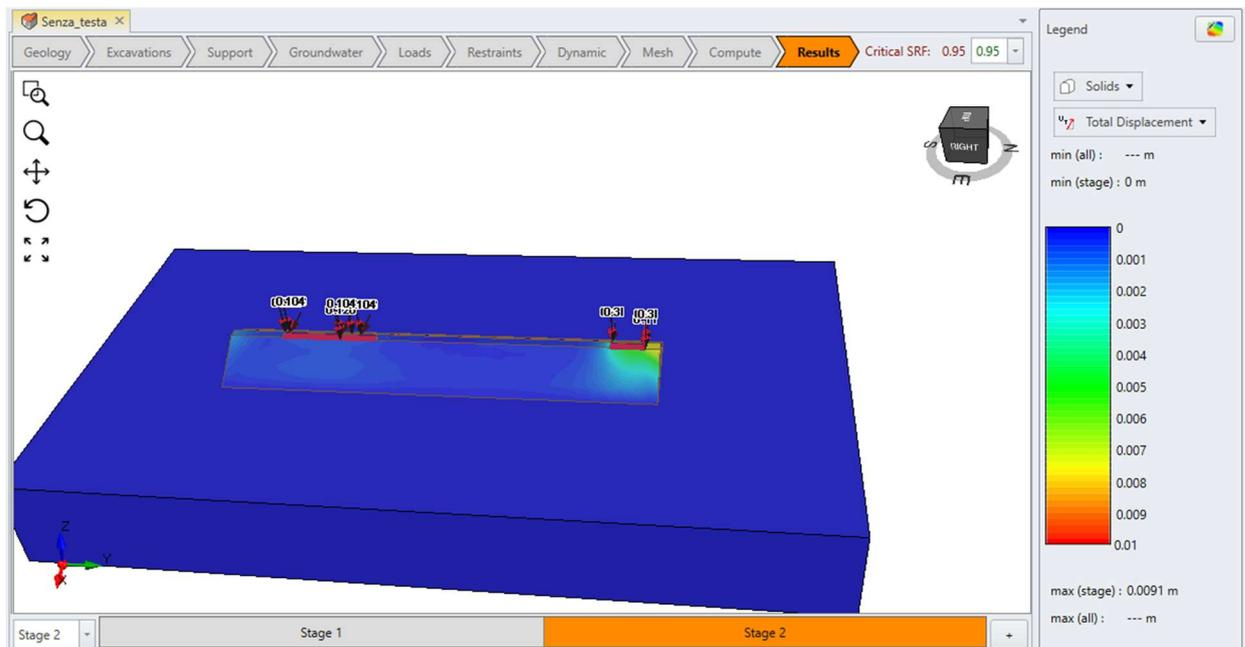
Figura 5-40 Fattore di sicurezza dell'opera e spostamento in condizioni del blocco di  $8 \text{ m}^3$  ed angolo di impatto orizzontale.
