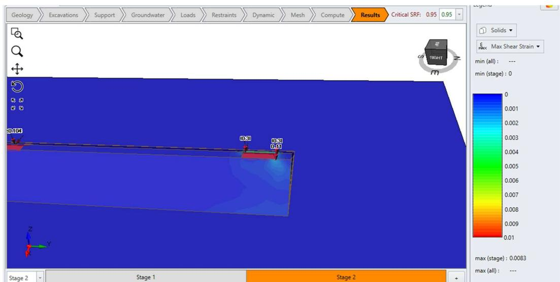
Figura 5-41 Max Shear strain condizioni del blocco di  $8 \text{ m}^3$  ed angolo di impatto orizzontale.
