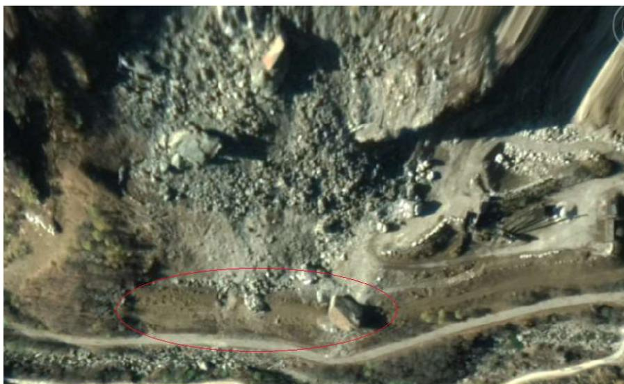
Figura 3-8 Zona del crollo e Rilevato Paramassi con la presenza dei due blocchi. Immagine Satellitare Google Earth (2016)
