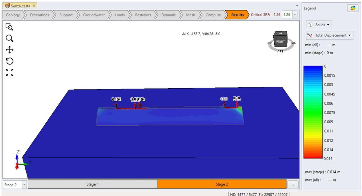
Figura 5-52 Fattore di sicurezza dell'opera e spostamento in condizioni del blocco di  $8 \text{ m}^3$  ed angolo di impatto verticale.
