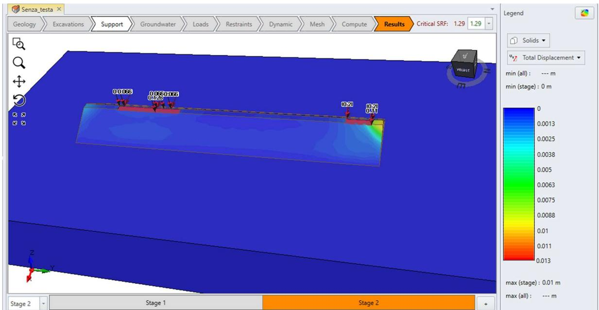
Figura 5-28 Fattore di sicurezza dell'opera e spostamento in condizioni del blocco di  $2.4 \text{ m}^3$  ed angolo di impatto pari a  $13^\circ$
