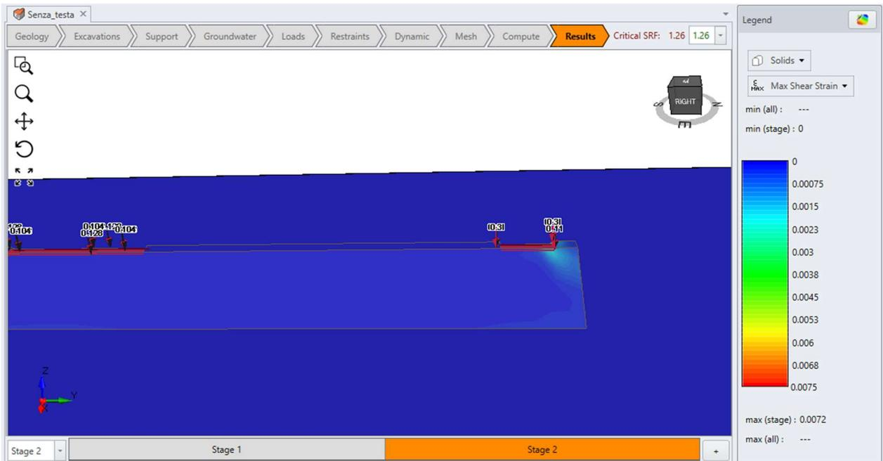
Figura 5-53 Max Shear strain condizioni del blocco di 8 m<sup>3</sup> ed angolo di impatto verticale
