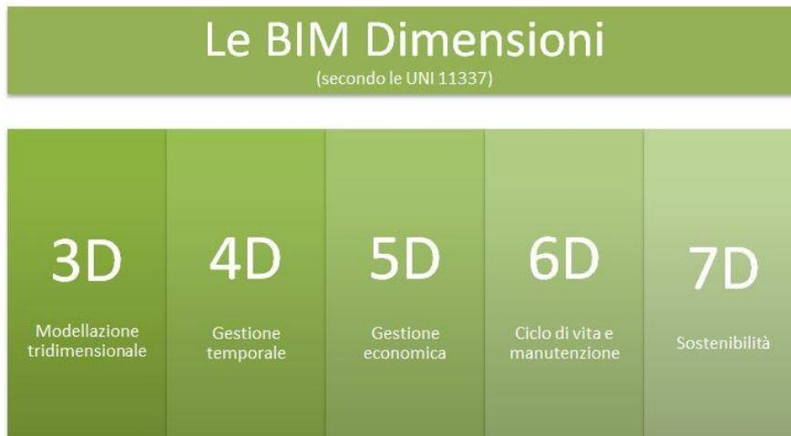
Figura 1.3 -Le 7 dimensioni del BIM secondo la norma UNI 11337 (Progettiamobim.com)
