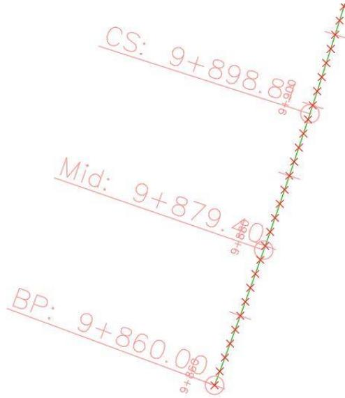
Figura 2.3.5 Stralcio planimetrico con i punti calcolati automaticamente
