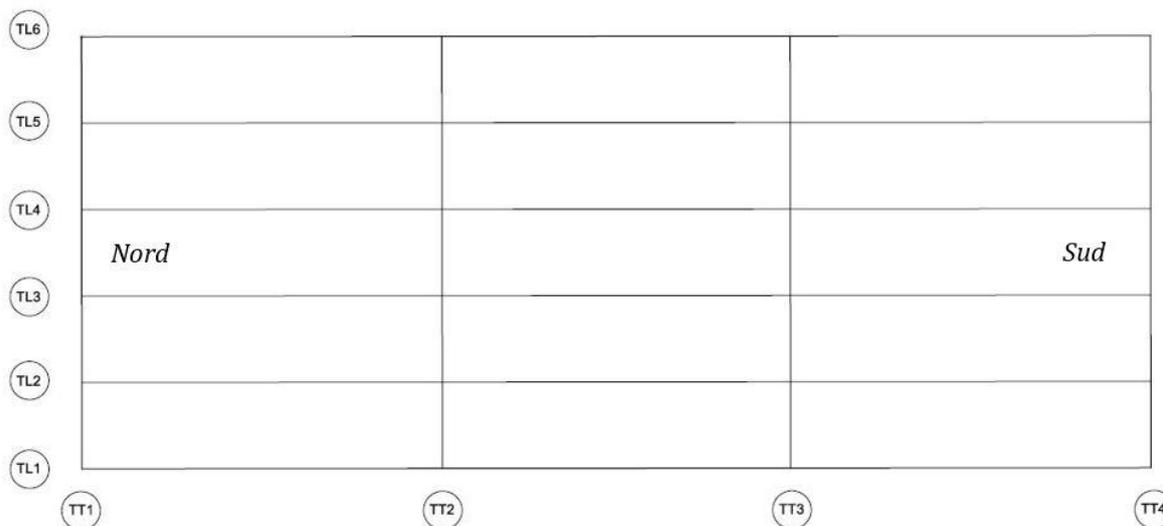
Figura 5.14 - Numerazione travi longitudinali e trasversali
