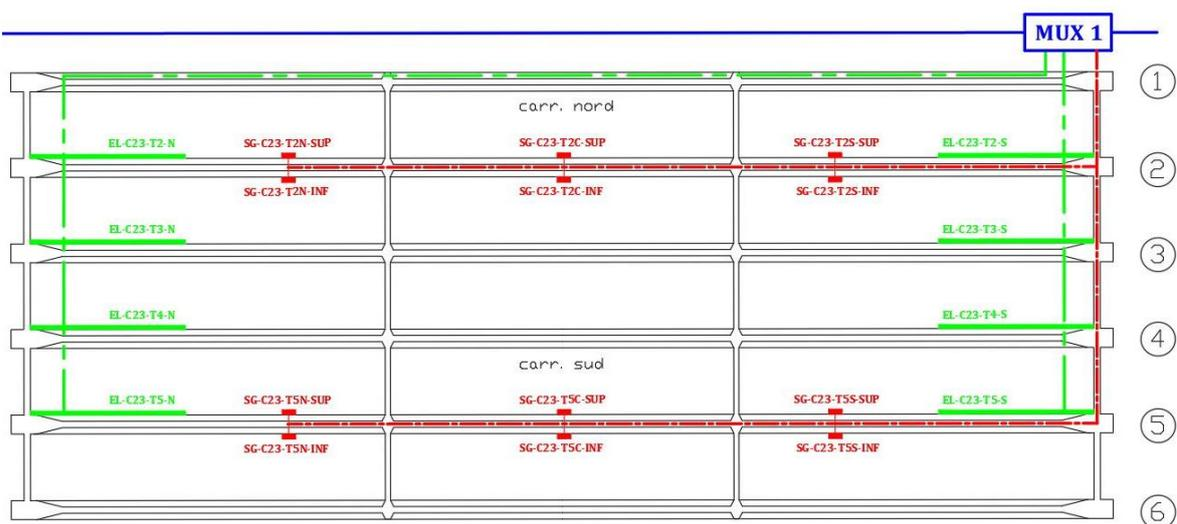
Figura 5.8 – Sensori del sistema di monitoraggio
