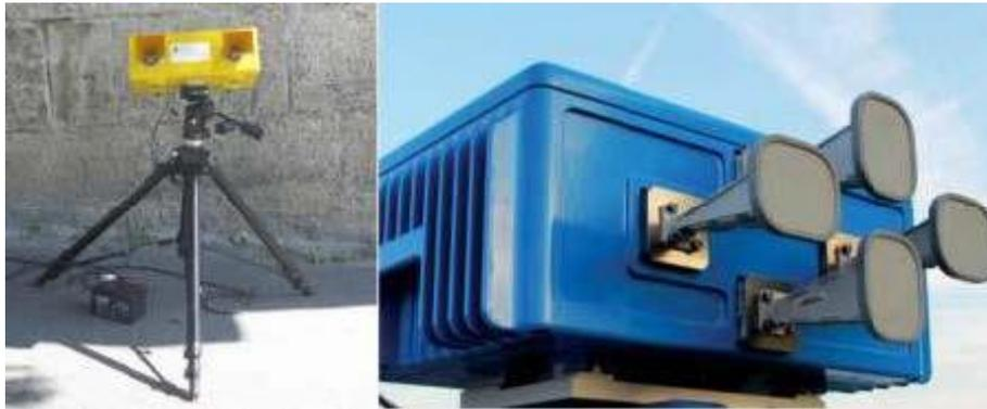
Figura 1.1 – Strumentazione per interferometria radar terrestre
