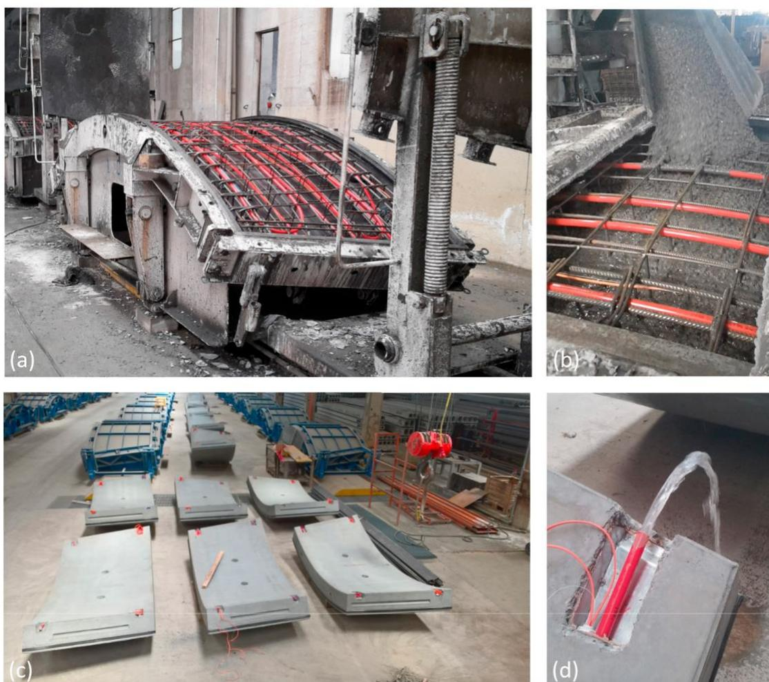
Figura 3.2 Fase di preparazione dei conci energetici: (a) stampo con armatura, (b) getto del calcestruzzo, (c) estrazione dallo stampo, (d) prova di circolazione (Barla et al., 2019b)
