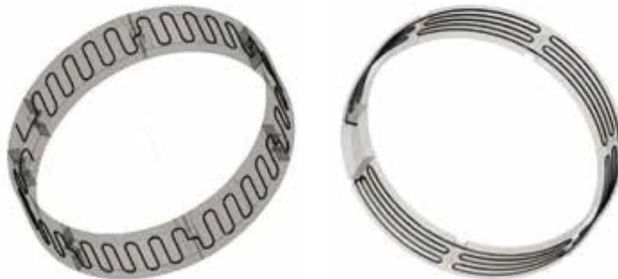
Figura 2.20 Anelli di rivestimento con diversa disposizione dei tubi di assorbimento (Barla and Di Donna, 2016)
