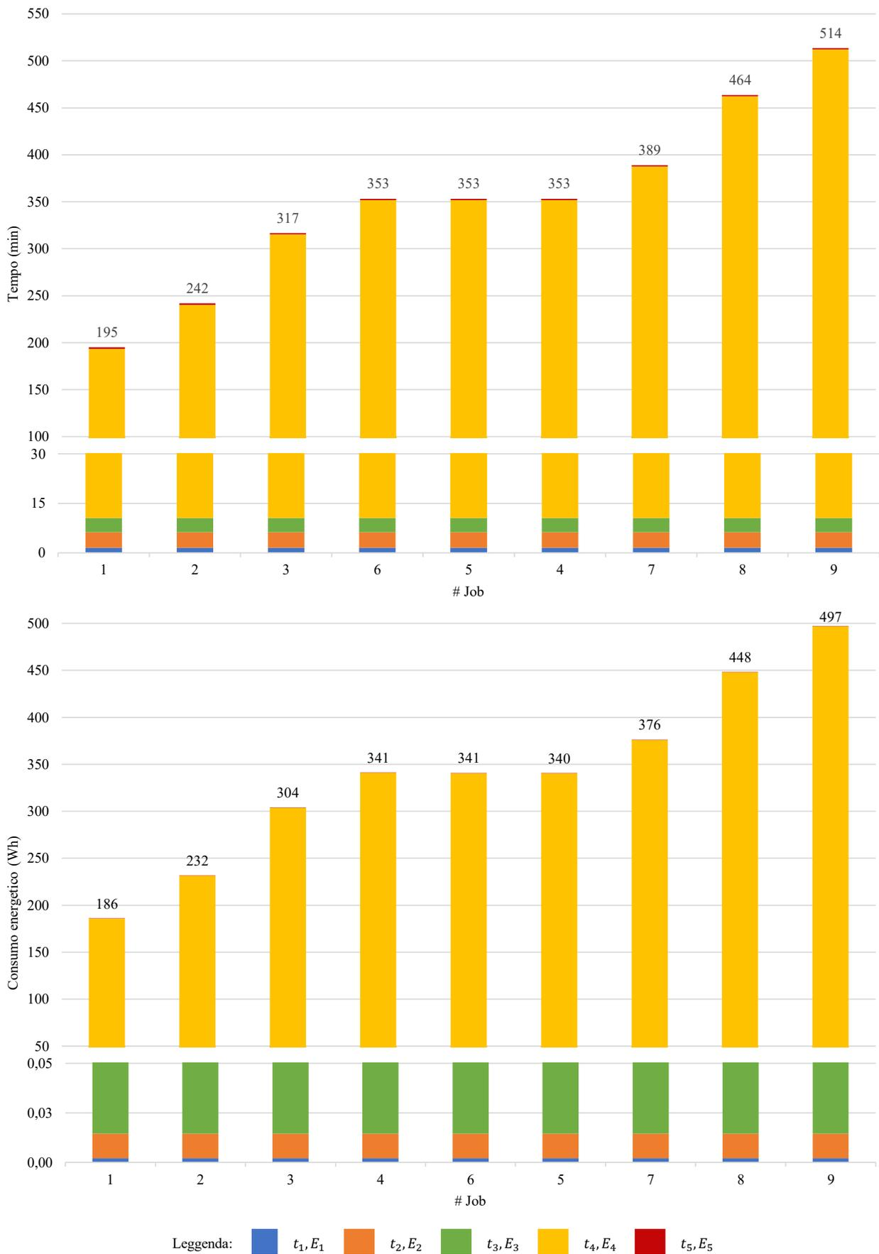
Figura 23 Risultati Makerbot Replicator: tempo di processo (in alto) e consumo energetico (in basso)
