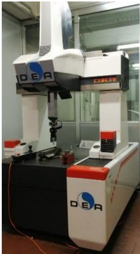
*Figura 19 Macchina di misura a coordinate (Hexagon DEA IOTA 0101)*
