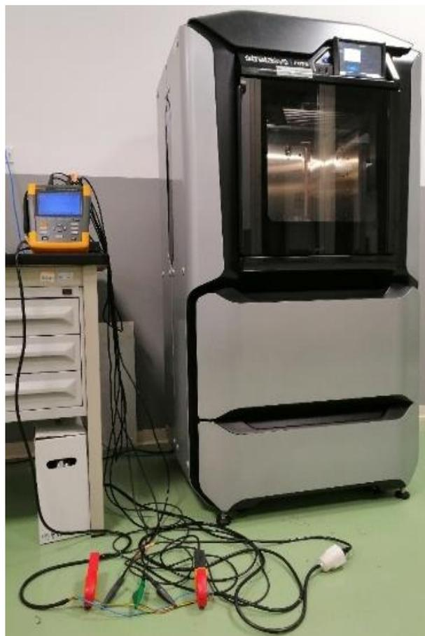
*Figura 15 Misuratore di potenza Fluke 435 serie II in funzione su Stratasys F370*
