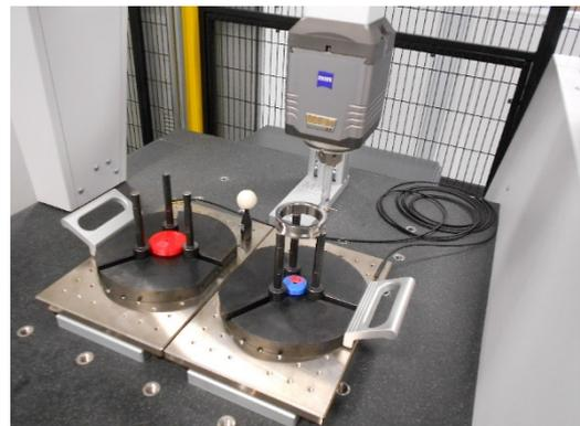
Figura 32 - Misurazione automatica anello interno
