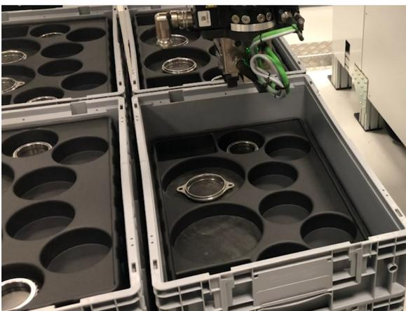
*Figura 39 - Appaiatura anelli per l'assemblaggio finale manuale*
