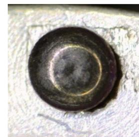
Figura 25- Esempio di rivettatura non conforme
