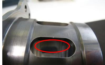
Figura 21-Esempio di ammaccatura
