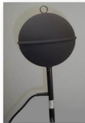
**Figura 82: Globotermometro**
