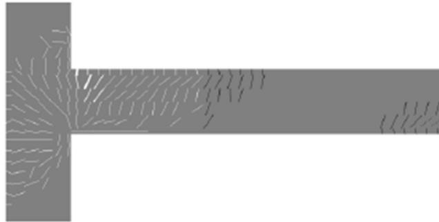
*Figura 59 Esempio di quadro fessurativo del calcestruzzo*
