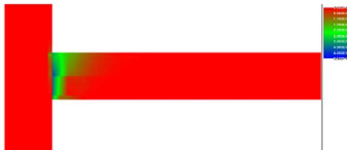
*Figura 61 Esempio di deformazioni nel calcestruzzo*
