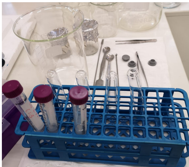
Figura 4.6: Preparazione sospensione nanobolle-acqua distillata deionizzata con rapporto 1:4
