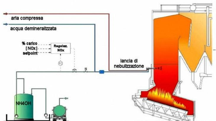
Figura 40: Impianto SNCR (Fonte: [18])
