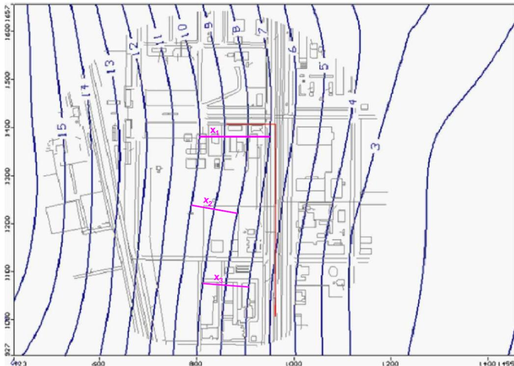
Figura 4.2 Piezometria indisturbata e lunghezze per il calcolo del gradiente idraulico (da Visual MODFLOW)
