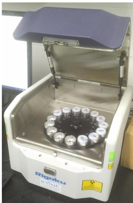
*Figura 17 Posizionamento del campione*
