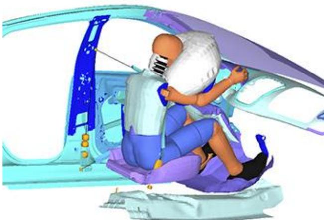
*Figura 22 Esempio di Modello MADYMO per incidenti automobilistici*
