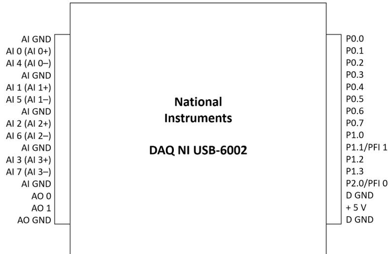
Figura 3.4: Pin della scheda d'acquisizione (DAQ).
