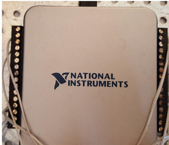
**Figura 3.3:** Scheda d'acquisizione dati (DAQ) NI USB-6002, prodotta da National Instruments.
