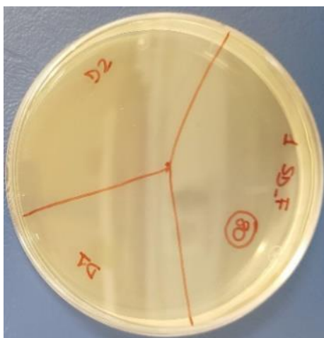
Figura 14: Piastra di Agar contenente i tre settori (soluzione concentrata, diluizione 1, diluizione 2)
