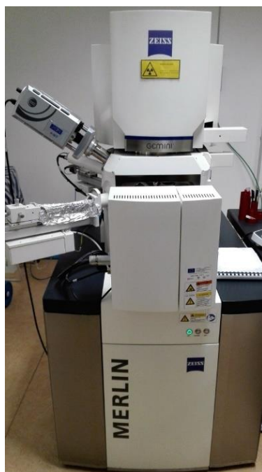
Figura 6: FESEM Merlin ZEISS equipaggiato con analizzatore EDS
