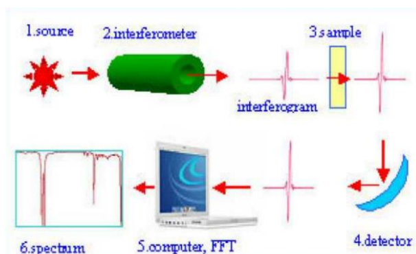
Figura 10: Schema di uno spettrofotometro FT-IR
