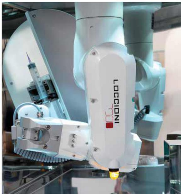
*Figura 9: manipolazione della siringa da parte del sistema APOTECachemo [7]*
