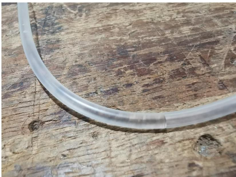
*Figura 46: tubo del dispositivo durante la prova di trasparenza. È possibile notare chiaramente l'interfaccia aria-acqua.*
