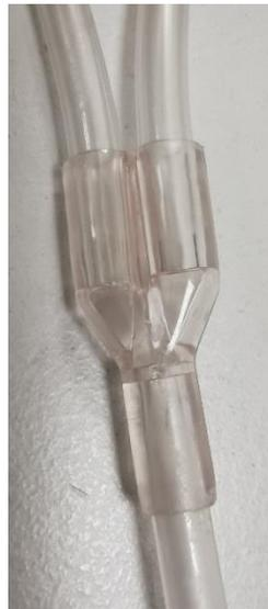
**Figura 18:** connettore a Y, utilizzato nel dispositivo per il dosaggio di farmaco e solvente all'interno di una sacca vuota
