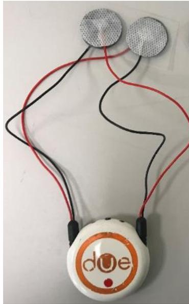
Figura 32 Sonda Due collegata agli elettrodi per il prelievo di segnali EMG di superficie.
