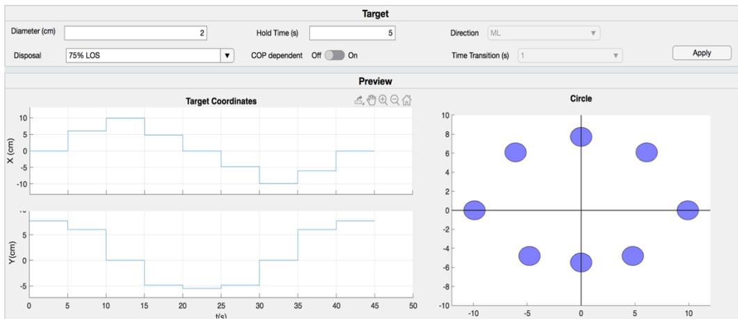
Figura 21 Esempio di impostazione dei parametri relativi al target nell'esercizio Circle e anteprima della disposizione dei target e della dinamicità del target mobile.
