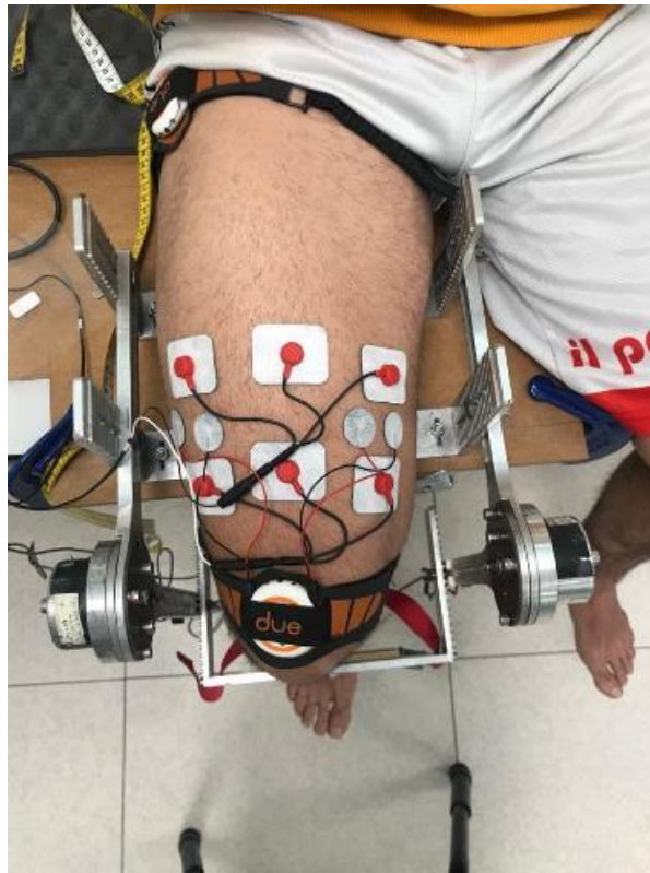
Figura 3.2.4.1: Posizionamento elettrodi in L1
