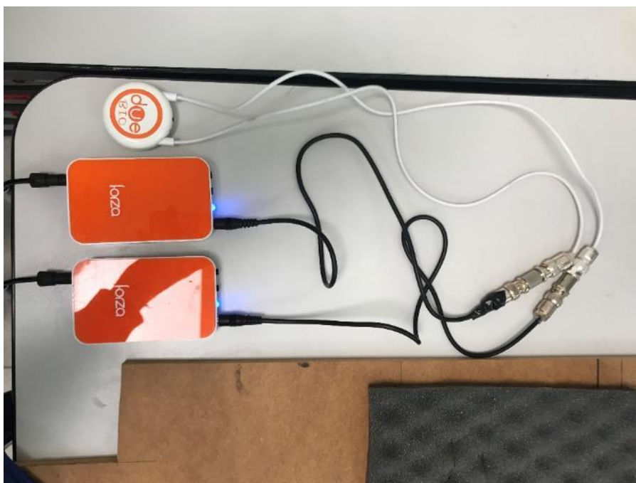
Figura 3.1.5.1: Sistema Forza (FZ005 ed FZ007) connesso ai due canali della sonda DueBio
