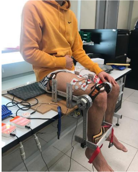
Figura 3.2.4.3: Posizionamento del soggetto sul trasduttore di coppia
