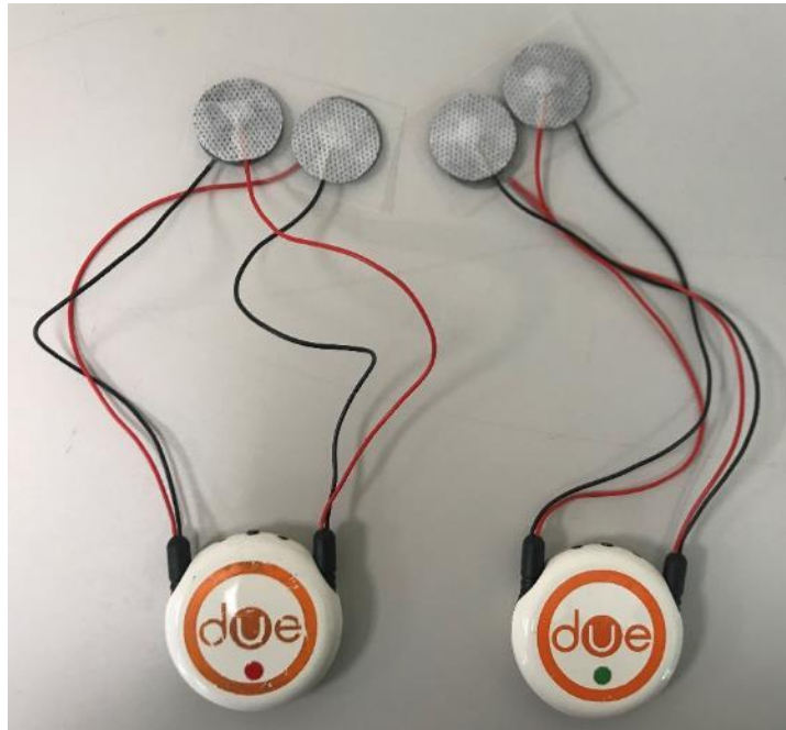
Figura 3.1.4.1: Sonde Due connesse agli elettrodi di prelievo
