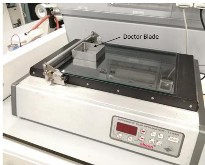
Figura 3.4: Automatic Film Applicator e doctor Blade.
