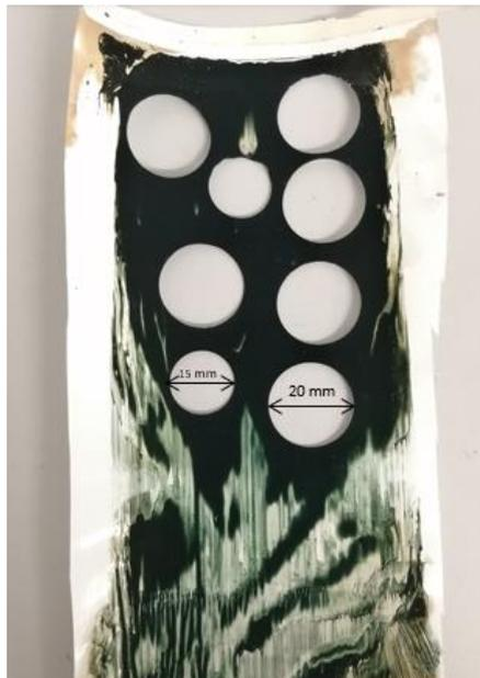
Figura 3.7: Stesa di PANI-HEO dalla quale sono già stati ricavati i tondini che poi verranno utilizzati nell'assemblaggio celle
