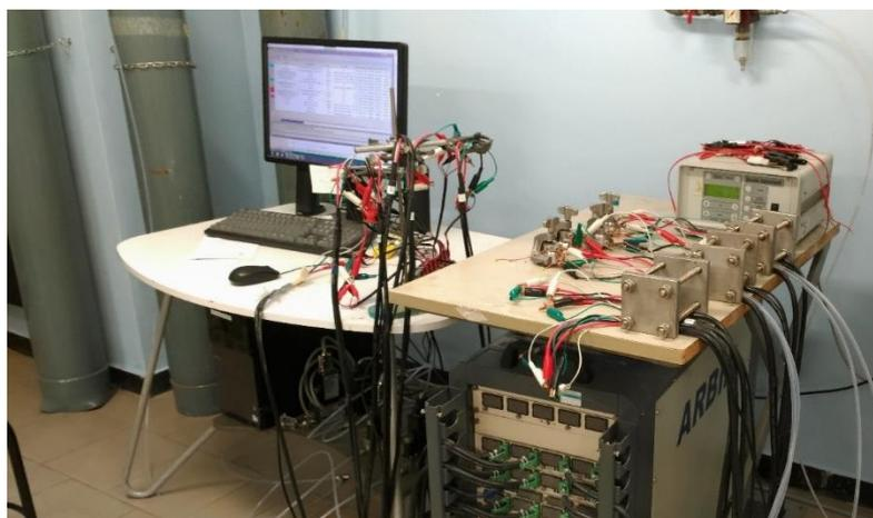
Figura 3.2: Ciclatore Arbin, sulla destra si possono vedere collegate delle EL-Cell in fase di ciclaggio
