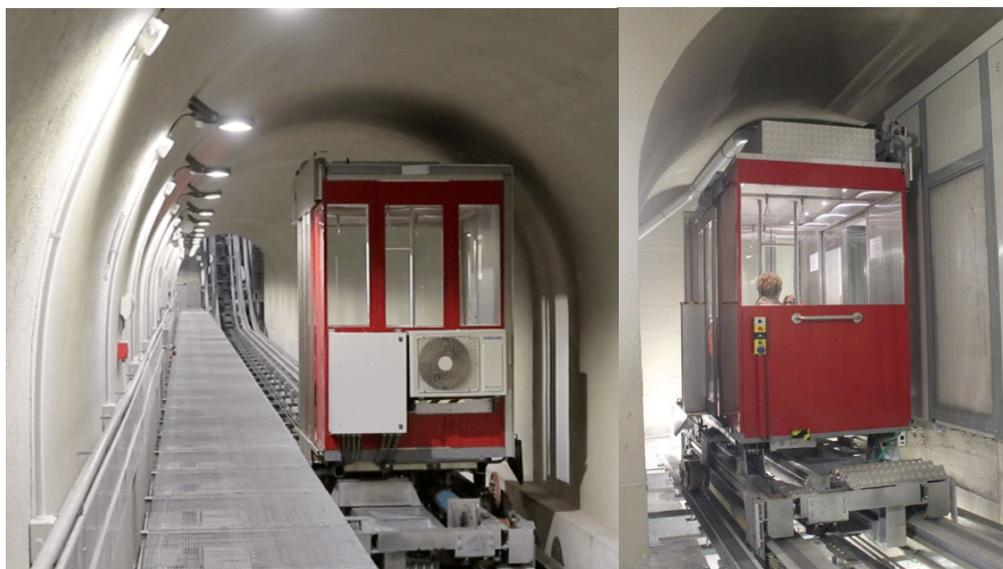
Fig. 3-16 – Cabina dell'ascensore Villa Scassi, dettaglio nel tratto orizzontale in galleria
