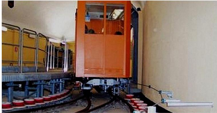
*Fig. 3-18 - La singola cabina con il sistema di trazione a pneumatici*
