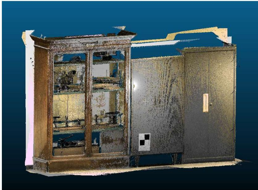
**Fig. 5.2.1.6** – Risultati allineamento nuvola lidar con nuvola F6 sul software CloudCompare
