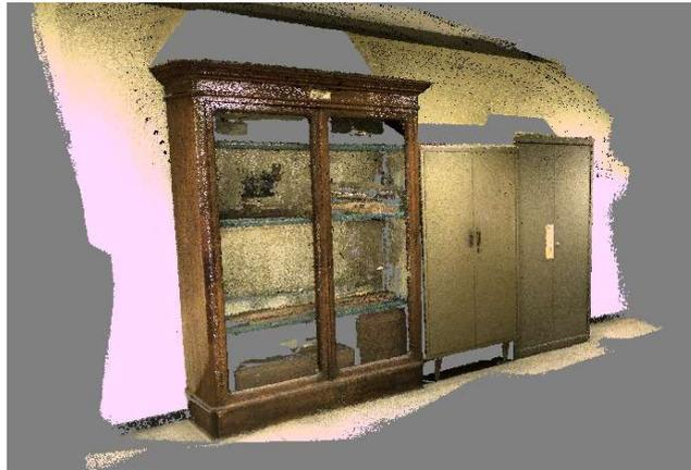
Fig. 4.4.2.1 - Nuvola filtrata ottenuta con luce strutturata F6
