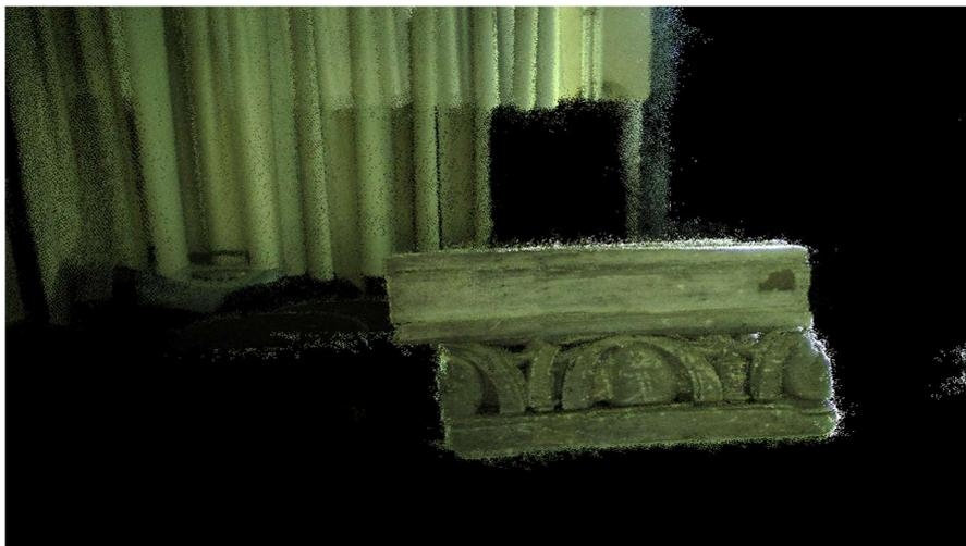
**Fig. 4.2.1.2** - Risultato della scansione n.2 con guadagno = 8 ed esposizione = 4
