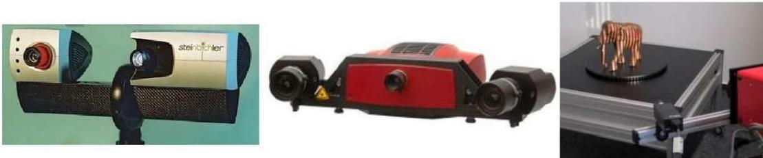
**Fig. 3.3.2** – Esempi di dispositivi che sfruttano la luce strutturata
