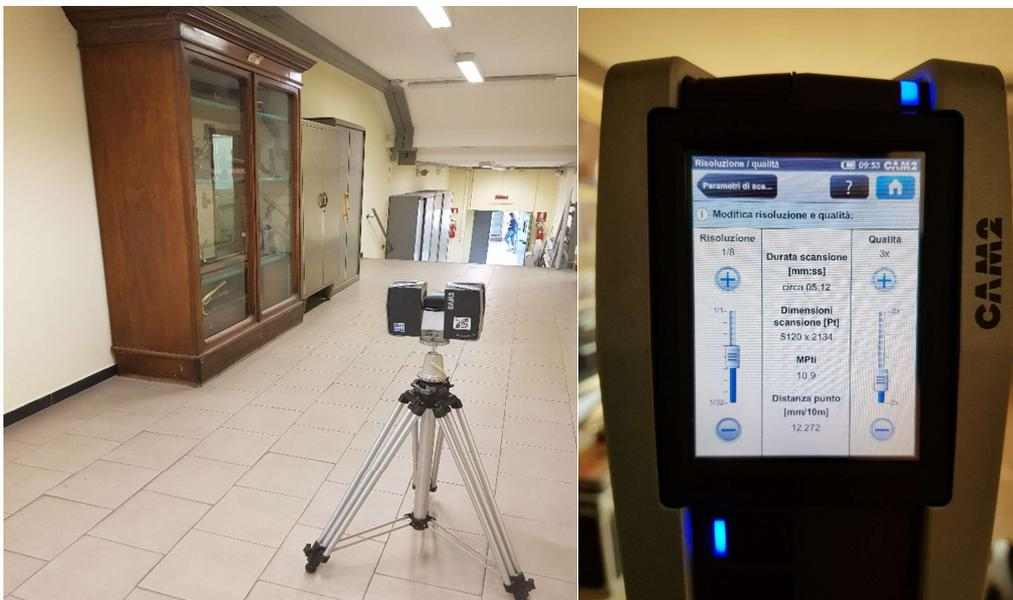
**Fig. 4.4.1.1** – Foto della vetrina e degli armadietti (a sinistra) e parametri utilizzati dal laser (a destra)
