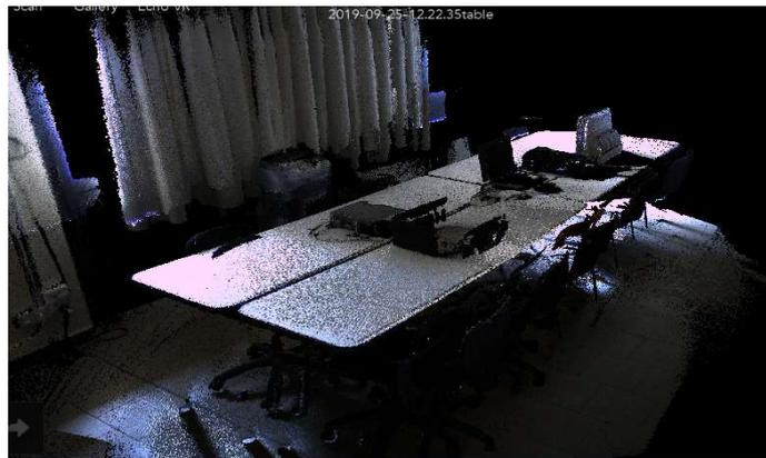
Fig. 4.3.1.1 – Risultato scansione n.1 del tavolo sul software ECHO
