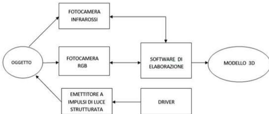
Fig. 3.3.1 - Schema a blocchi di uno scanner a luce strutturata
