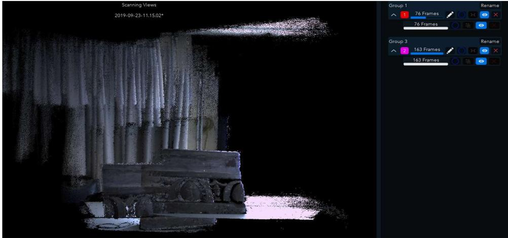
**Fig. 4.2.1.1** - Risultato della scansione n.1 con guadagno = 2 ed esposizione = 4
