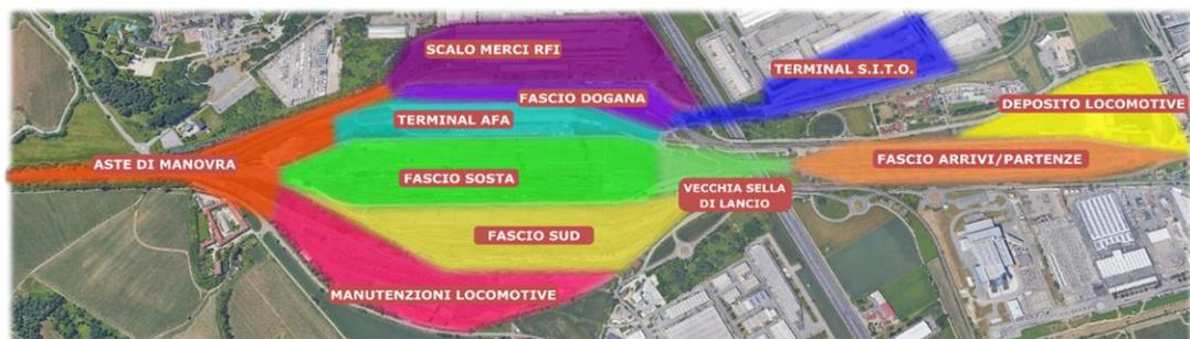
Figura 47: Microaree della piattaforma logistica (fonte: Analisi informazioni raccolte)
