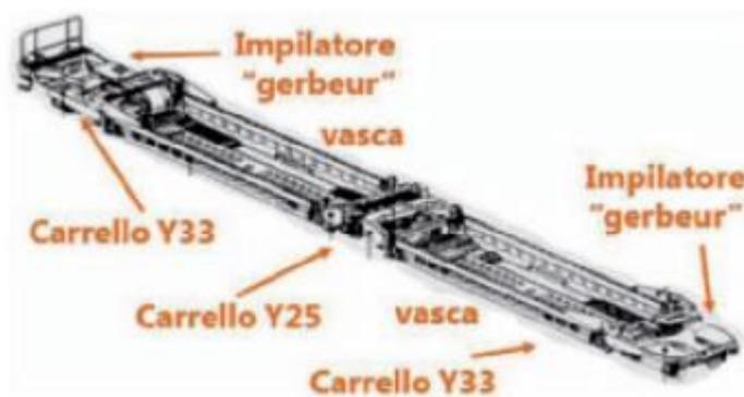
Figura 45: Struttura di un carro Modalohr (fonte: Quaderno 10 Osservatorio Torino-Lione)
