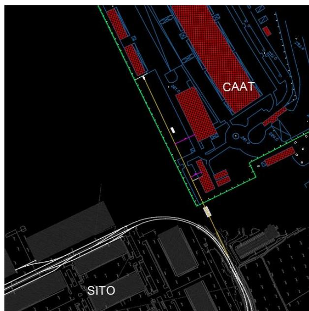
Figura 95: Estratto Autocad del raccordo ferroviario tra le infrastrutture di SITO ed il CAAT
