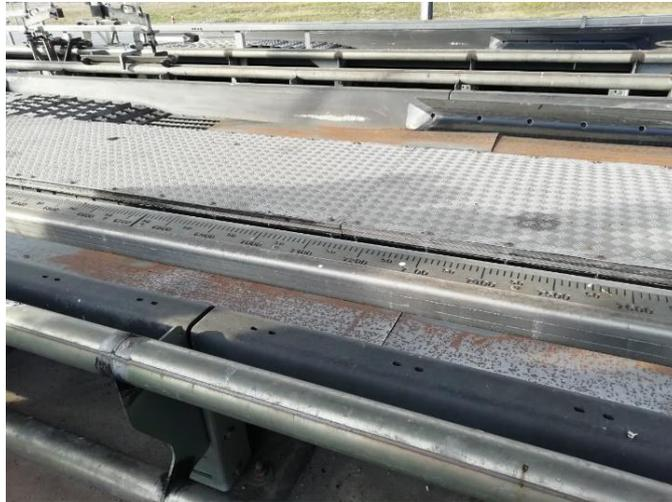
Figura 42: Dispositivo per la verifica della lunghezza del mezzo in ingresso (fonte: Sopralluogo del 15-01-2020)
