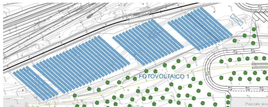
Figura 85: Estratto dello spazio carta di Autocad rappresentante il parco fotovoltaico 1
