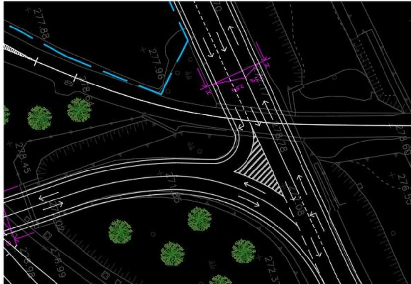
Figura 72: Estratto Autocad dell'intersezione e della riorganizzazione di Strada del Portone
