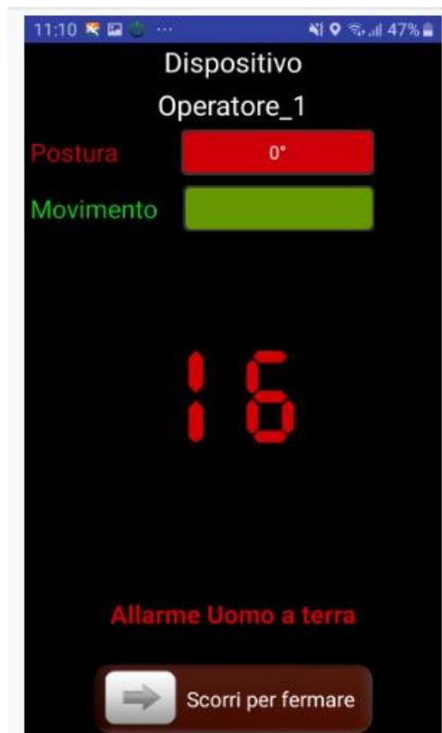
Figura 42 - avvio allarme locale e conto alla rovescia per notifica remota
