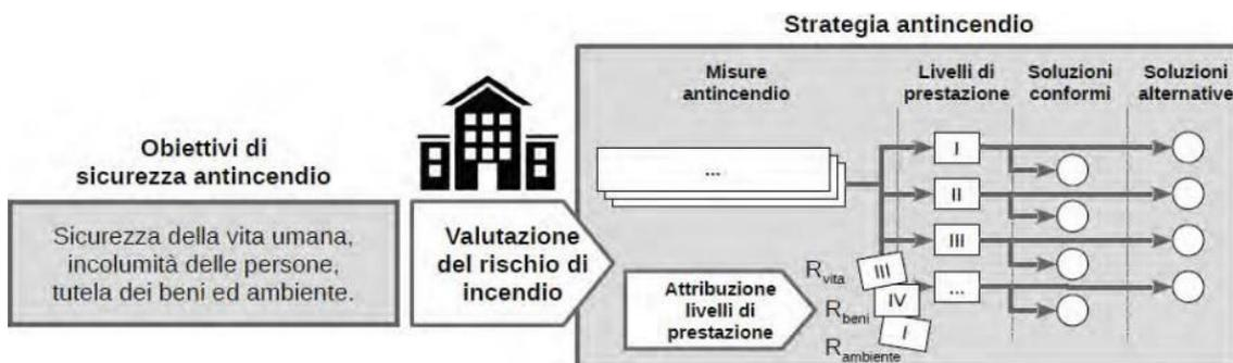
Figura 50 - Schematizzazione della metodologia generale
