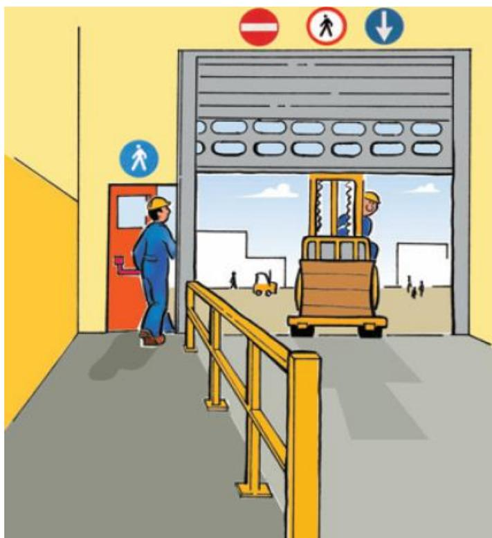
*Figura 34 - barriera di protezione tra il percorso pedonale e quello destinato ai carrelli, in corrispondenza di un'uscita*
