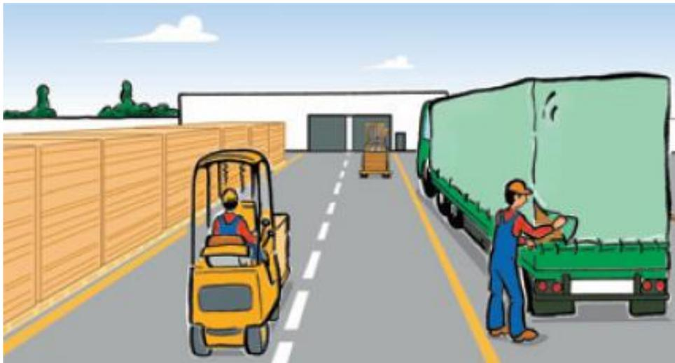
*Figura 27 - via di transito interna a un'azienda con larghezza che permette lo scarico di un veicolo pesante di trasporto*
