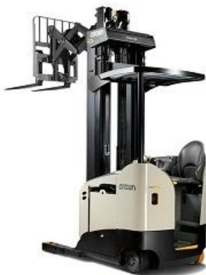
Figura 6 : carrello retrattile a pantografo
