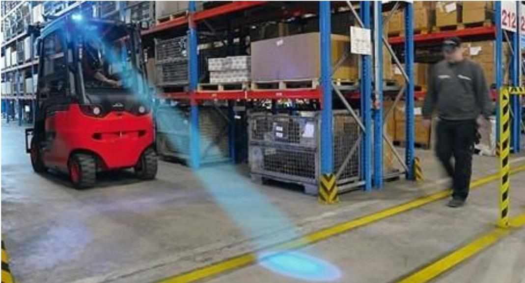
*Figura 39 - utilizzo di luci blu per i mezzi di stoccaggio*
