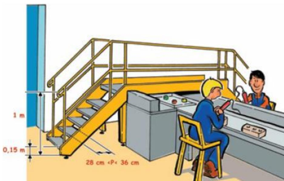
Figura 33 - passerella con parapetto, sopra una linea di produzione
