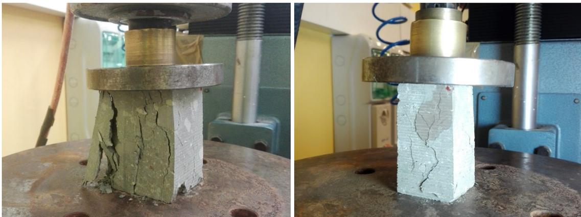
*Figura 3.7: Provini 1 ( a sinistra) e 2 (a destra) a fine prova. È possibile osservare fratture longitudinali con andamento tortuoso che si sviluppano intorno ai blocchi; nel caso del campione 2 si nota un blocco di argilla molto sovraconsolidata che viene anche fratturato.*
