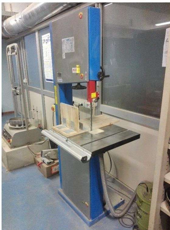
*Figura 3.1: Sega a nastro utilizzata per la realizzazione dei provini.*
