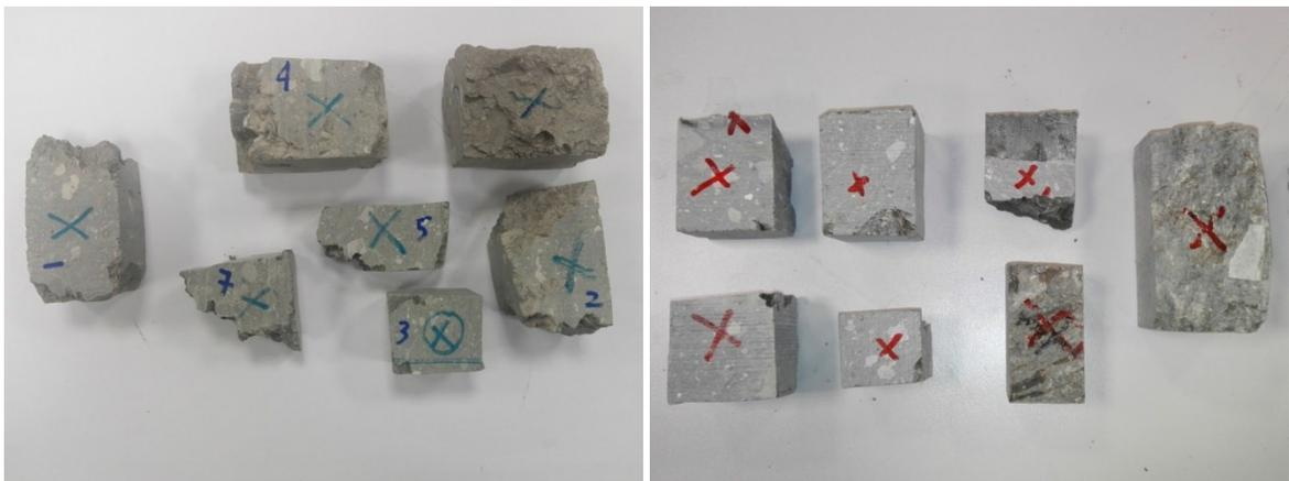
Figura 3.17: Alcuni dei campioni di mélange sottoposti a prova point-load: campioni con contenuto d'acqua naturale a sinistra e campioni secchi a destra.
