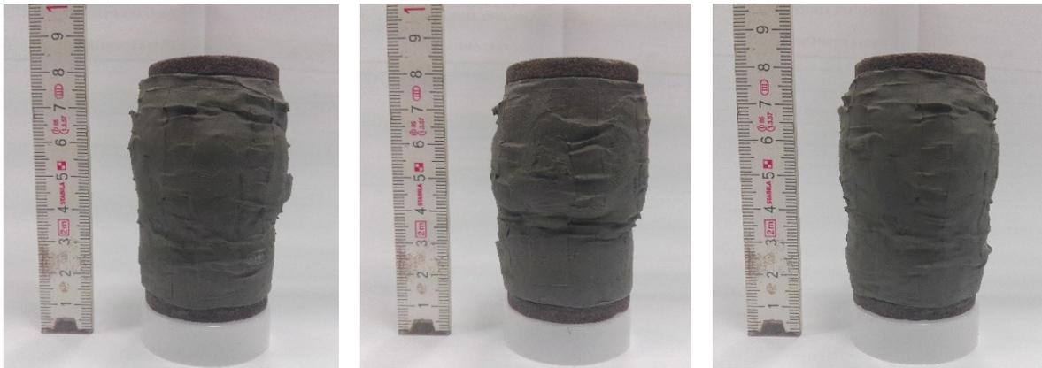
*Figura 5.16: Aspetto del provino con VBP=50% alla fine della prova triassiale. Non si rileva una localizzazione della superficie di taglio in quanto la rottura è avvenuta in maniera diffusa.*
