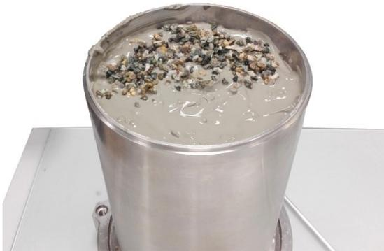
Riempimento del cilindro del consolidometro
