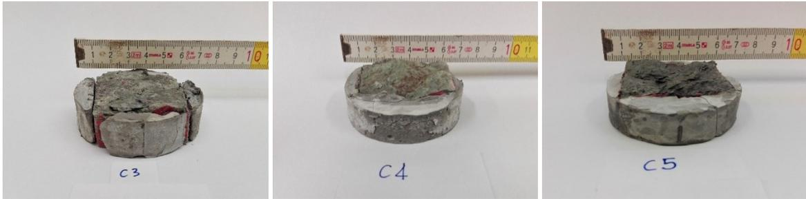
*Figura 4.4: Superfici di rottura dei provini 3, 4 e 5 ottenute dalle prove di taglio diretto.*
