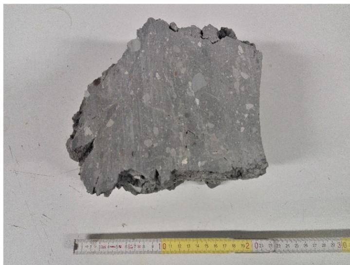
Figura 2.4: Spezzone del bimrock in esame
