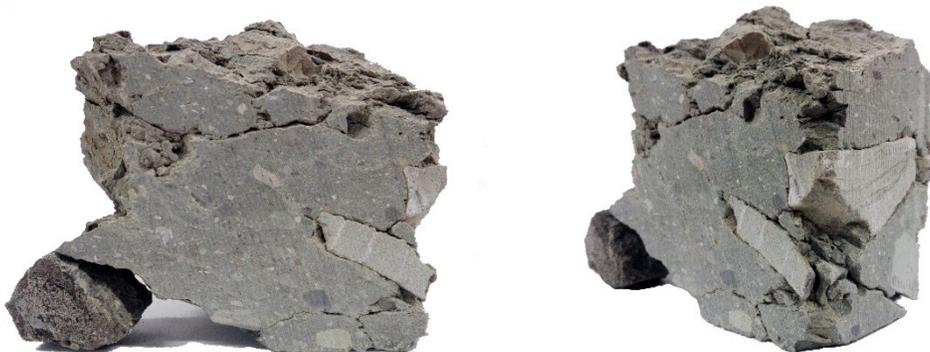
*Figura 2.10: Spezzone del mélange in esame. È possibile osservare come la dimensione massima dei blocchi osservabile su una faccia esposta sia significativamente differente dal valore reale.*
