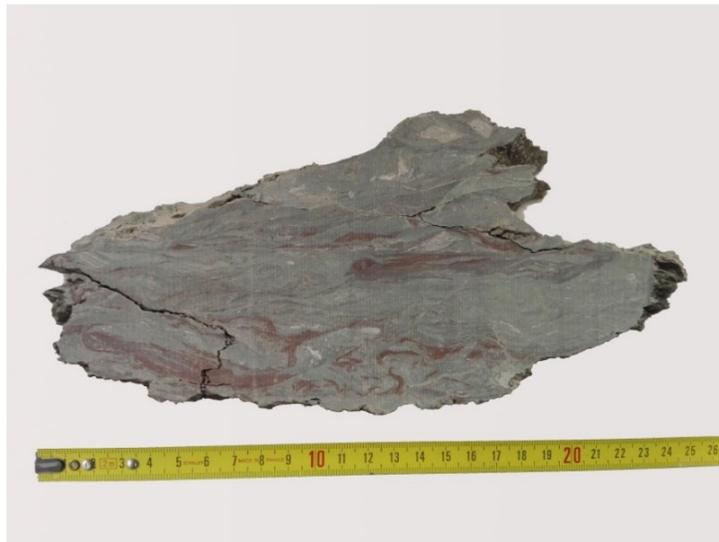
Figura 2.3: Spezzone di matrice del bimrock in esame.
