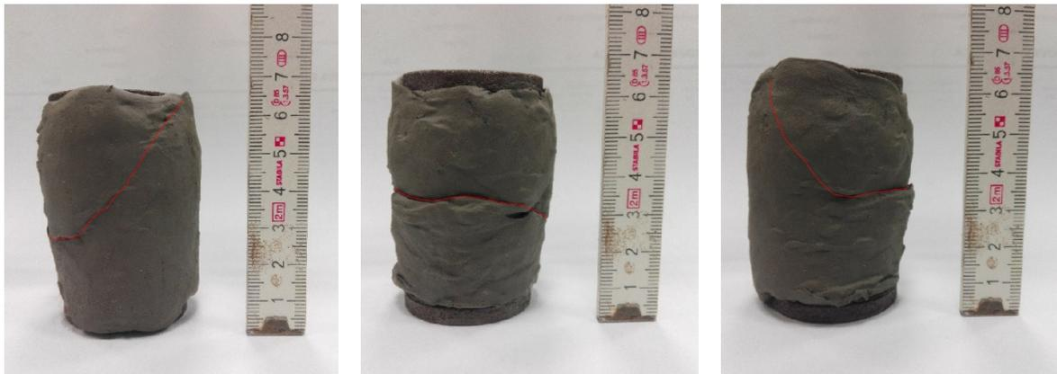
Figura 5.15: Aspetto del provino con VBP=25% alla fine della prova triassiale. È possibile osservare la deviazione della superficie di rottura per effetto della presenza dei blocchi.
