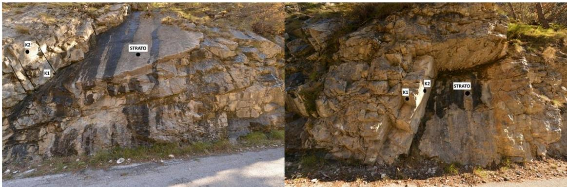
*Figura 6.3: Foto del settore A1\_b con indicazione dei piani che possono andare svincolare blocchi.*
