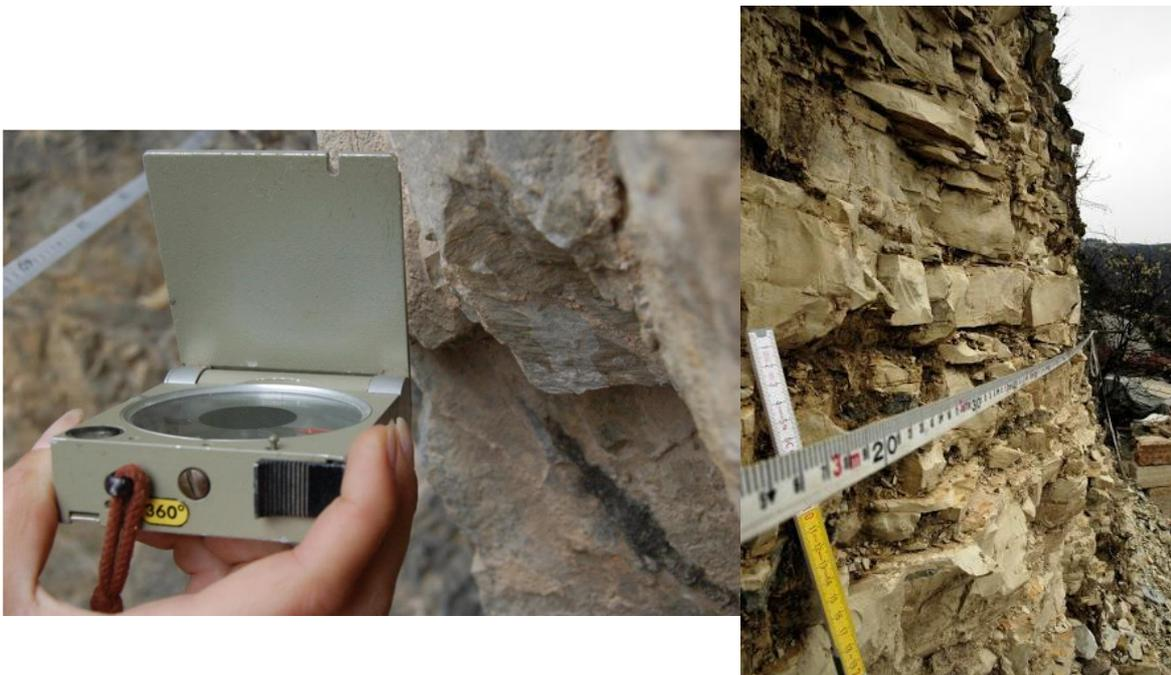
Figura 2.10: Bussola e scanline per il rilievo delle discontinuità.
