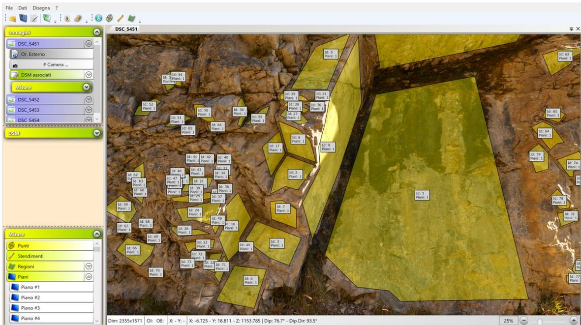
Figura 5.2: Selezione dei piani di discontinuità tramite il software Rockscan, esempio del settore A1\_b.
