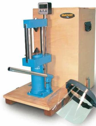
Figura 2.19: Attrezzatura per il *Point Load Test*.
