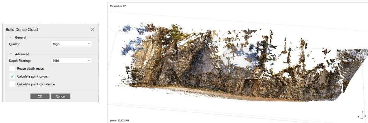
Figura 4.15: (a sinistra) Generazione della nuvola densa, (a destra) nuvola densa per il settore A1\_b.
