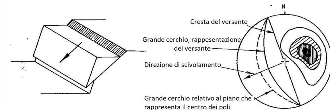
Figura 2.21: Meccanismo di scivolamento planare (Hoek & Bray, 1981).
