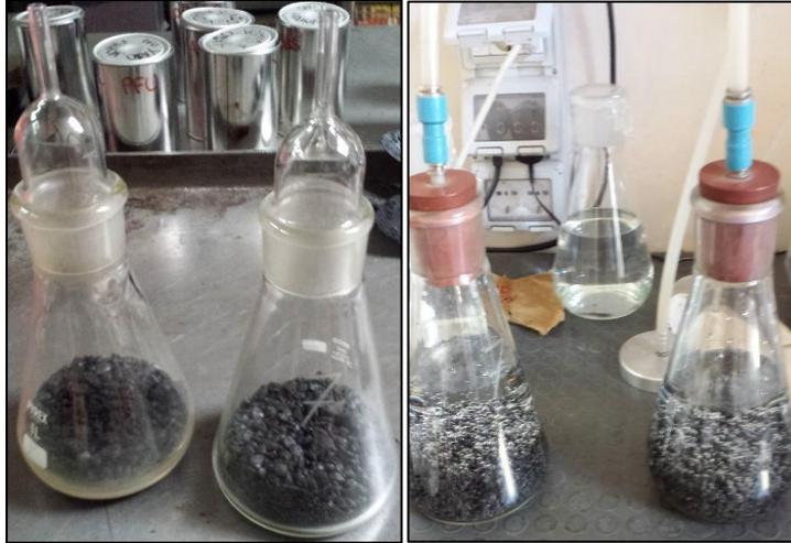
**Fig. 4.4** Picnometro con materiale (a) e fase di disaerazione (b)
