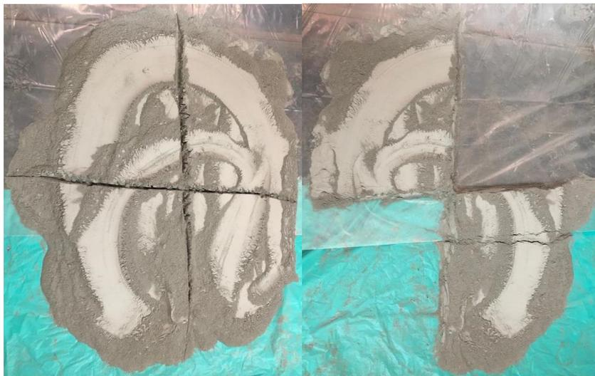
**Fig. 4.5** Suddivisione del campione in quattro parti (a) e esclusione di due parti opposte (b)
