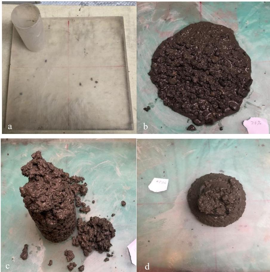
**Fig. 4.9** Prova di spandimento: tavola e cilindro (a), miscela a elevato contenuto d'acqua (b), miscela in condizione prismatica (c) e miscela assestata su se stessa (d)
