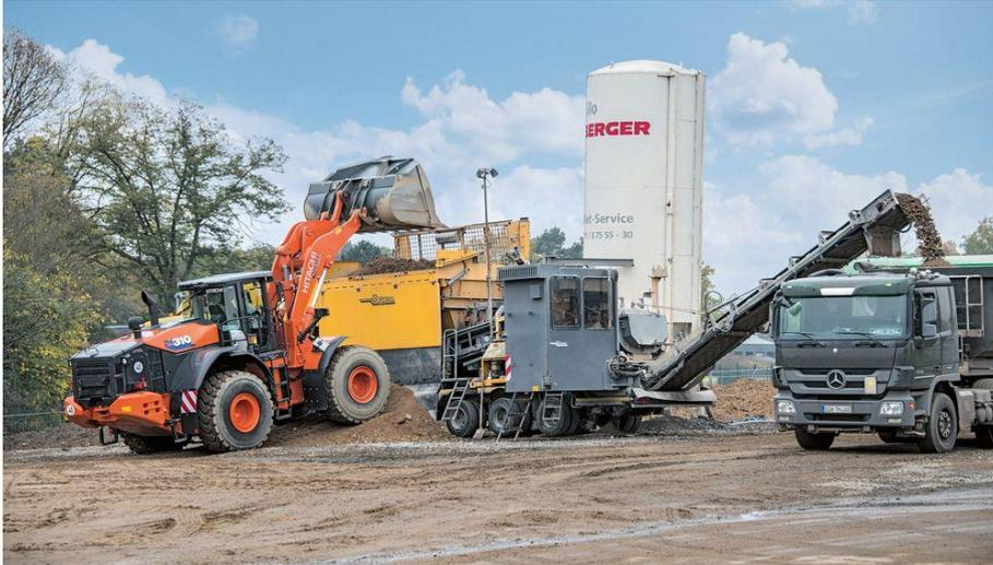
**Fig. 2.9** Riciclaggio in impianto mobile
