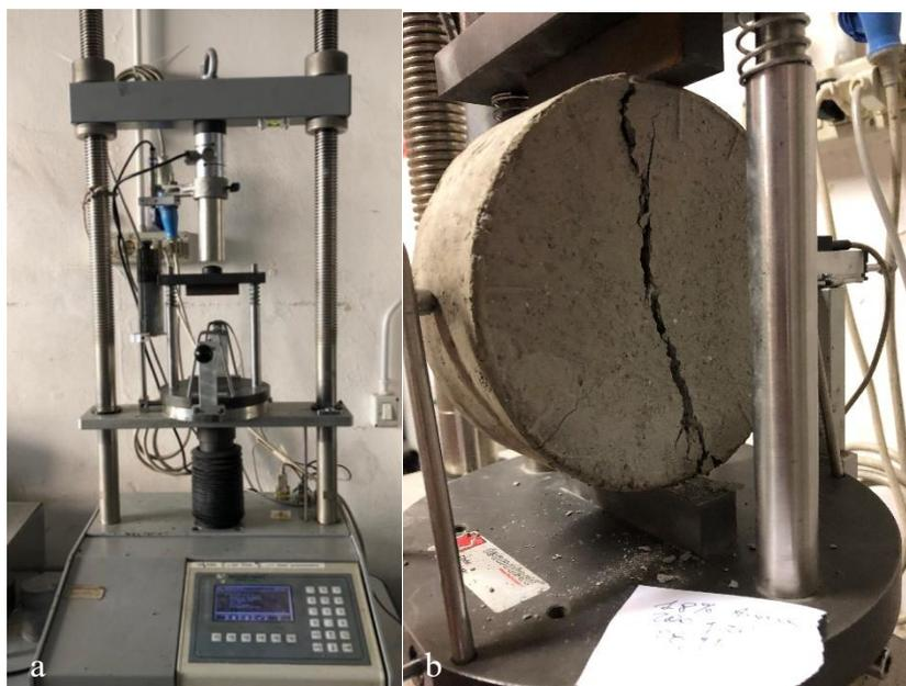
Fig. 4.15 Pressa statica (a) e configurazione di prova (b)
