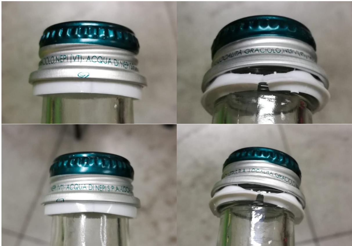
Figura 3.13 - Chiusure spring prima e durante l'apertura in ORIOS M27DF 116 (sopra) e ORIOS M27DF 224 (sotto)
