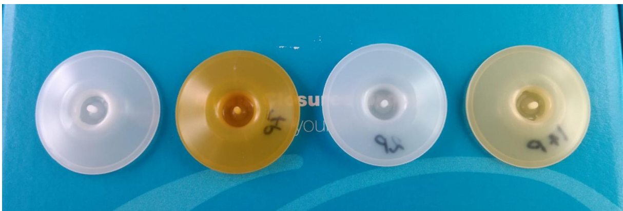
Figura 3.21 - WAD in materiale compostabile stampati correttamente. Partendo da sinistra, Wad tal quale, dopo immersione in Whiskey, dopo immersione in vodka e dopo immersione in olio
