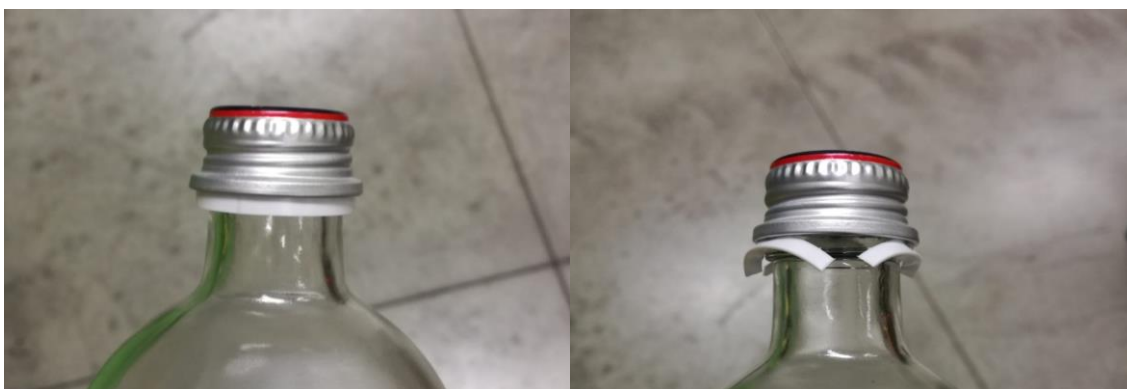
Figura 3.7 - Chiusura spring con LDPE SPB 681 bianco prima (sinistra) e durante (destra) l'apertura.
