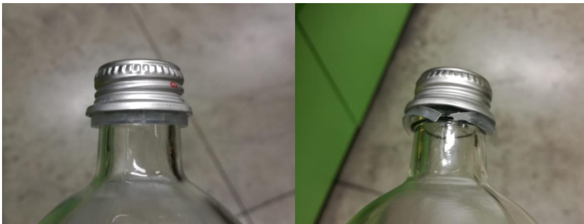
Figura 3.4 - Chiusura applicata prima dell'apertura (a sinistra) e durante l'apertura con le alette alzate (a destra)
