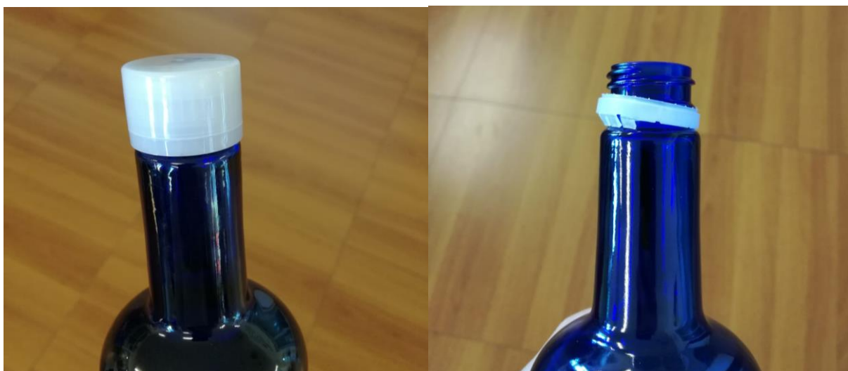
Figura 3.25 - Chiusura Bikini in bio-PE applicata su bottiglia e anellino TE in seguito all'apertura, con le alette fuori posizione
