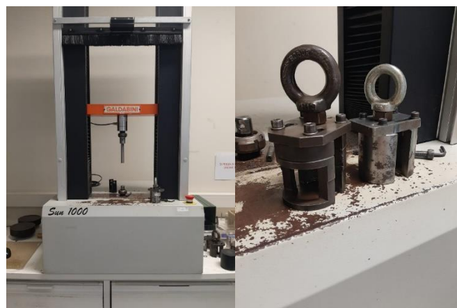
Figura 2.14 – Dinamometro (a sinistra) e attrezzi di trazione (a destra)
