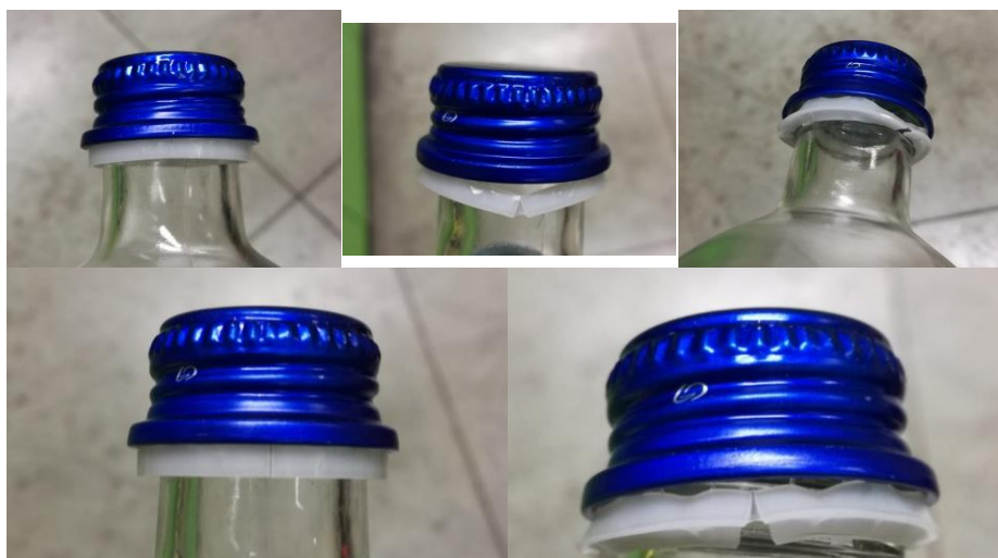
Figura 3.10 - Chiusure in ORIOS B7 M52717 (sopra) e ORIOS B7 M61929 (sotto), a sinistra prima dell'apertura, a destra durante.
