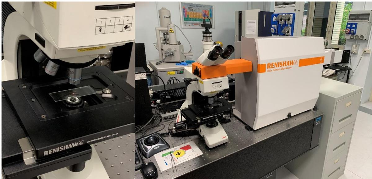
Figura 4.3: Sensore SERS posizionato sul microscopio confocale (a sinistra) e spettrometro Raman accoppiato a microscopio confocale (a destra).
