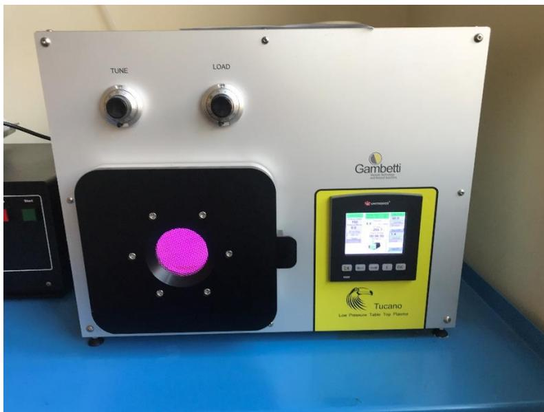
*Figura 2.5: Strumentazione Tucano per trattamento con plasma a bassa pressione.*
