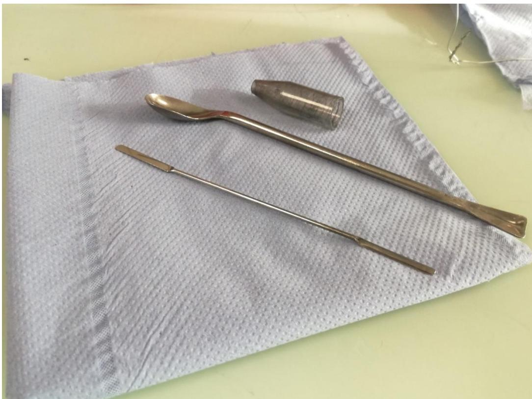
**Fig.2.30:** strumenti da laboratorio utilizzati nel corso della fase sperimentale; dal basso verso l'alto: scovolino metallico, spatola per il dosaggio delle polveri e imbuto in materiale plastico ricavato partendo dal taglio di un porta-campione.
