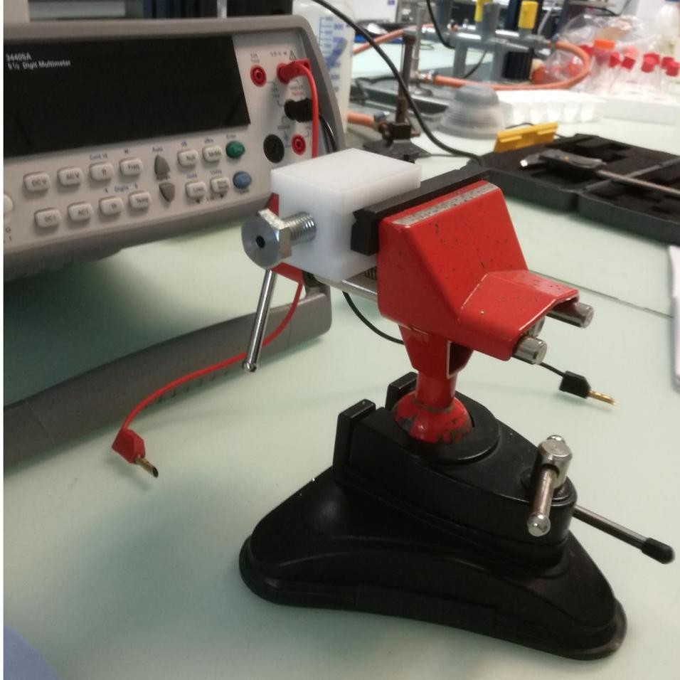
**Fig. 2.32:** sistema nella sua versione definitiva in POM inserito nella morsa dello stativo da banco tramite le sedi laterali nella sua configurazione orizzontale.
