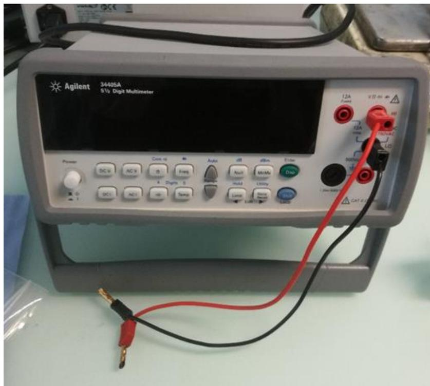
**Fig.2.16:** multimetro modello Agilent 34405A (HP) inizialmente utilizzato per le misure preliminari in DC.
