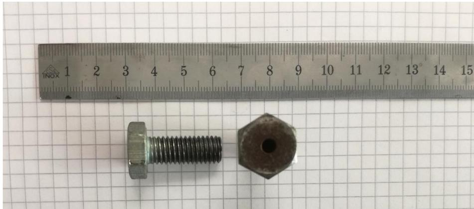
**Fig.2.24:** particolare delle viti in acciaio zincato con filettatura M10 utilizzate per la realizzazione del sistema sperimentale.
