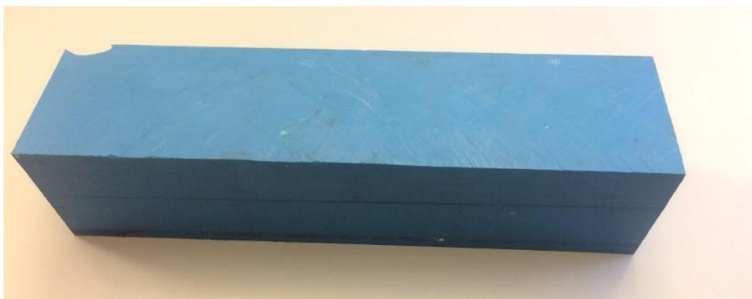
**Fig.2.6:** semilavorato di partenza in poliuretano termoplastico M960 della Sikablock®.
