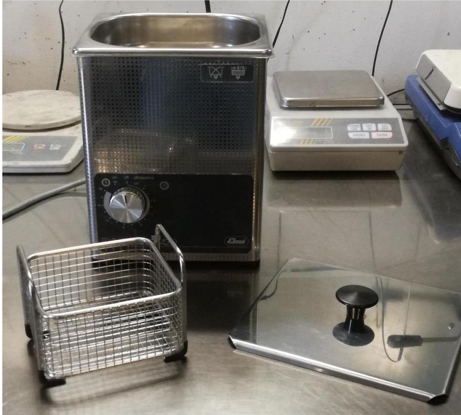
**Fig. 2.33:** sonicatore modello TRANSSONIC T420 (Elma®) utilizzato per la pulizia dello strumento.
