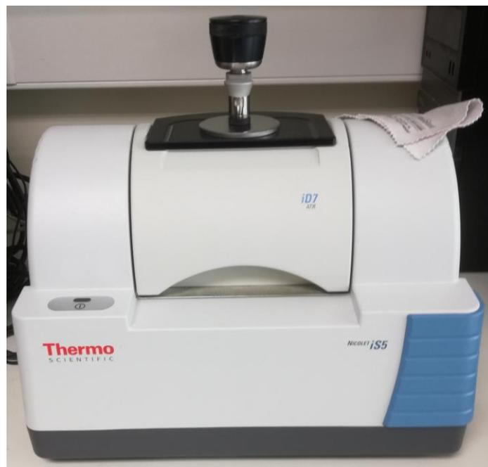
**Fig.2.9:** spettrometro IR modello Nicolet iS5 (Thermoscientific) utilizzato per la caratterizzazione chimica del materiale per la realizzazione di parte della seconda versione prototipo.
