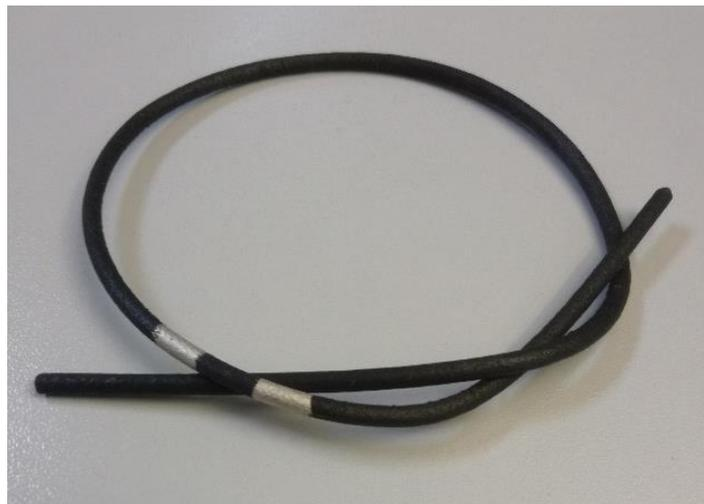
**Fig.1.16:** spaghetti estruso con pasta d'argento applicata per eseguire test di conducibilità elettrica secondo normativa UNI EN ISO 3915.
