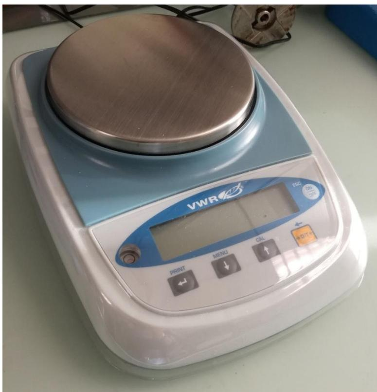
**Fig.2.29:** bilancia digitale da laboratorio modello SE 1202 (VWR®, leggibilità di 0,01 gr.) utilizzata per il dosaggio delle polveri all'interno del sistema.
