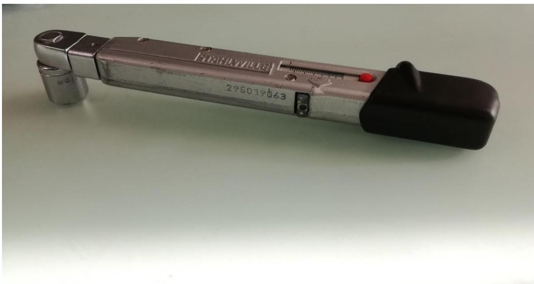
**Fig. 2.31:** chiave dinamometrica modello MANOSKOP 730/4, (capacità 8-40 Nm, STAHLWILLE) utilizzata per impartire al sistema la coppia meccanica.
