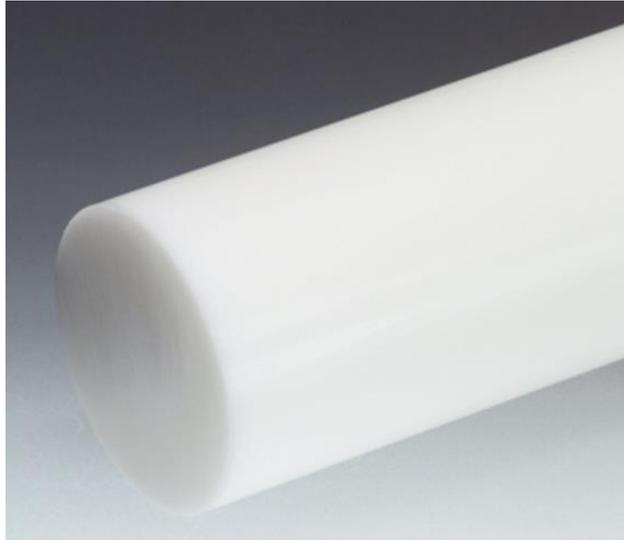
**Fig.2.17:** tondo in POM bianco della Angst+Pfister, semilavorato di partenza per la realizzazione del portacampione [5].
